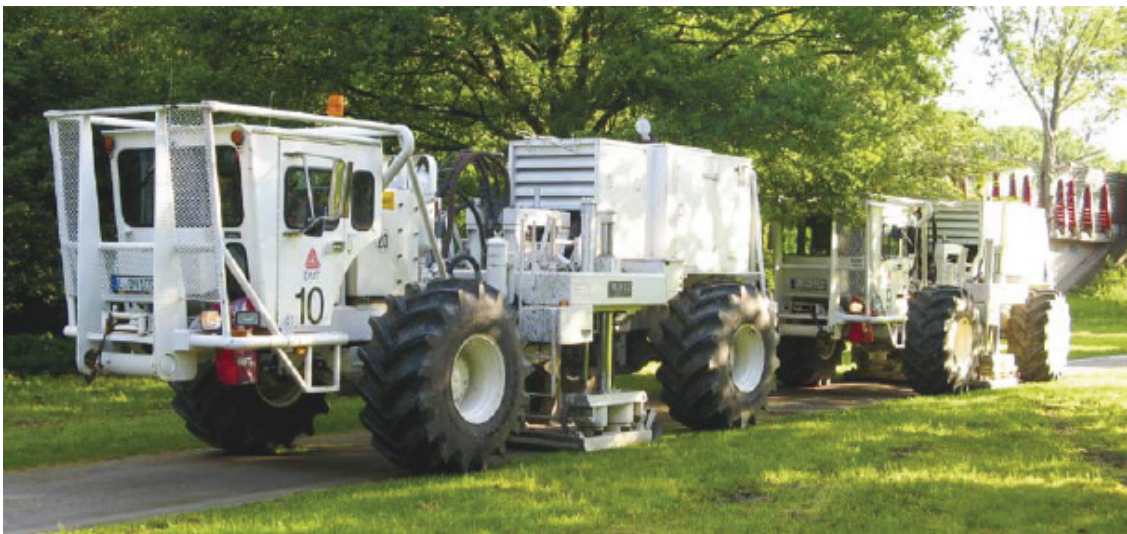
Abb. 7.16 Seismische Erkundung durch Vibrotrucks
