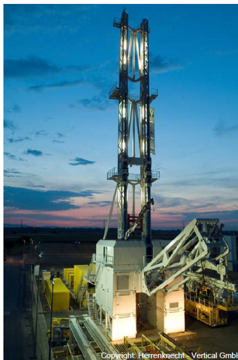
Abb. 7.14 Bohrturm für tiefe Bohrungen der Firma Herrenknecht /VOL 14/
