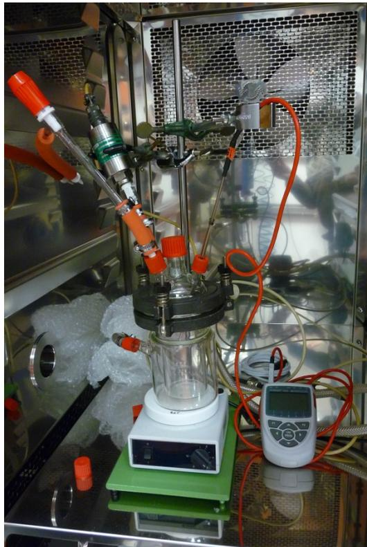
**Abb. 2.2** Apparatur zur direkten Bestimmung von Dampfdrücken wässriger Lösungen
