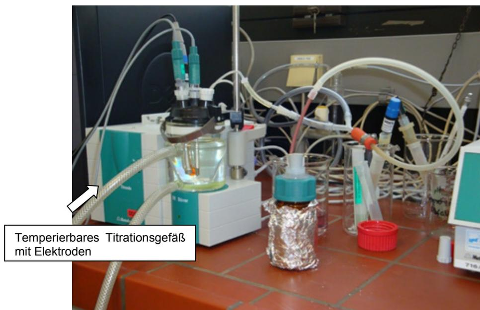
**Abb. 3.16** Versuchsaufbau für die potentiometrischen Messungen hydrogensulfidhaltiger Salzlösungen
