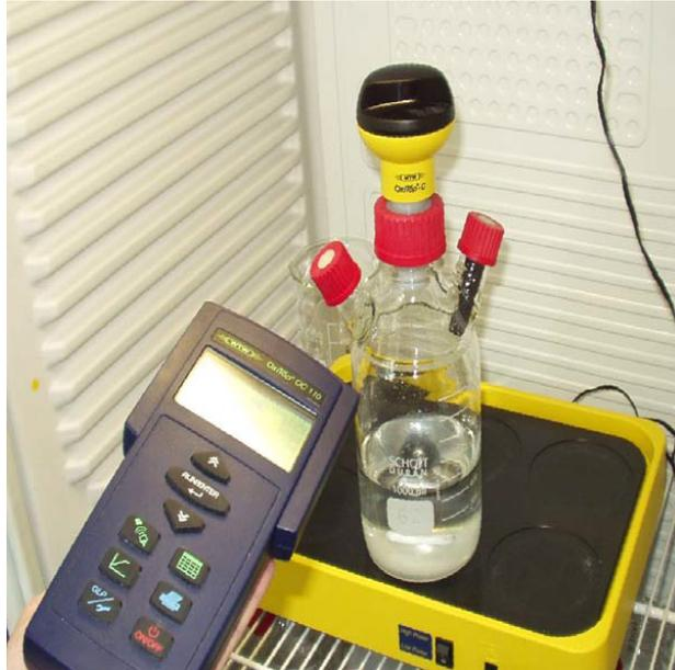
**Abb. 3.2** Versuchsaufbau zur Bestimmung der  $\text{H}_2\text{S}$  (aq)-Sättigungskonzentration. WTW-OxiTOP-System im Thermoschrank mit Messflasche, Druckmesskopf, Mehrfachrührstelle und Controller
