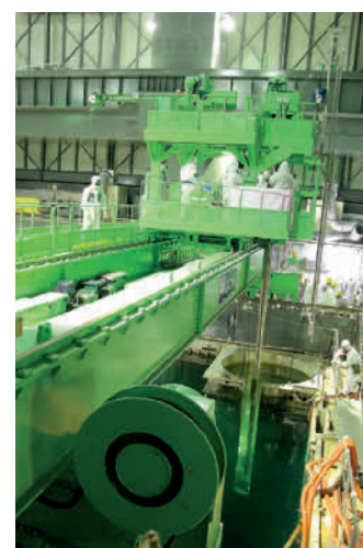
Abb. 6.25: Transportbehälter in Beladeposition (links) und Blick in die Brennelement-Wechselmaschine (rechts) (Quelle: TEPCO).
