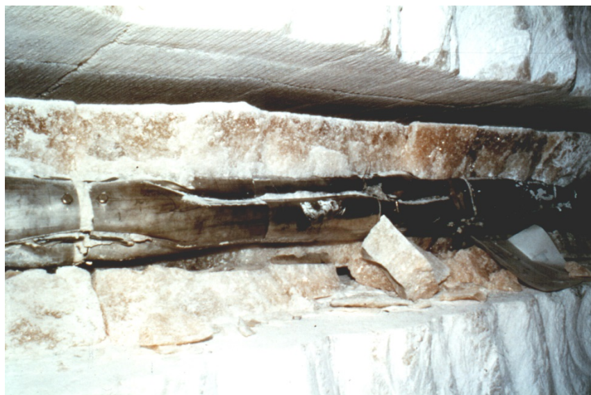
Abb. 10.2 Freigelegter Erhitzer aus dem TSS-Versuch, Schachtanlage Asse II /ROT 99/
