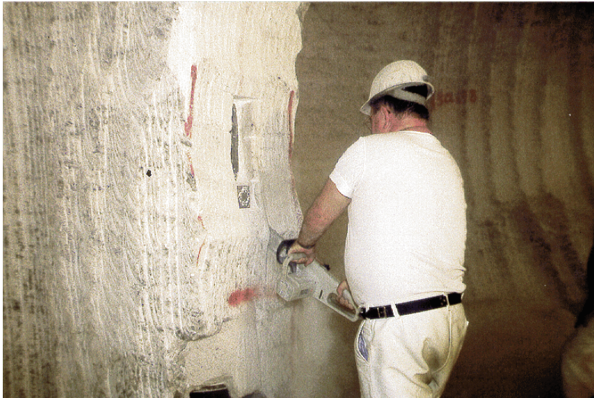
Abb. 10.1 Bohrkerngewinnung von kompaktiertem Salzgrus aus der Schachtanlage Asse II, 800 m-Sohle im Rahmen des Debora-Vorhabens /ROT 99/
