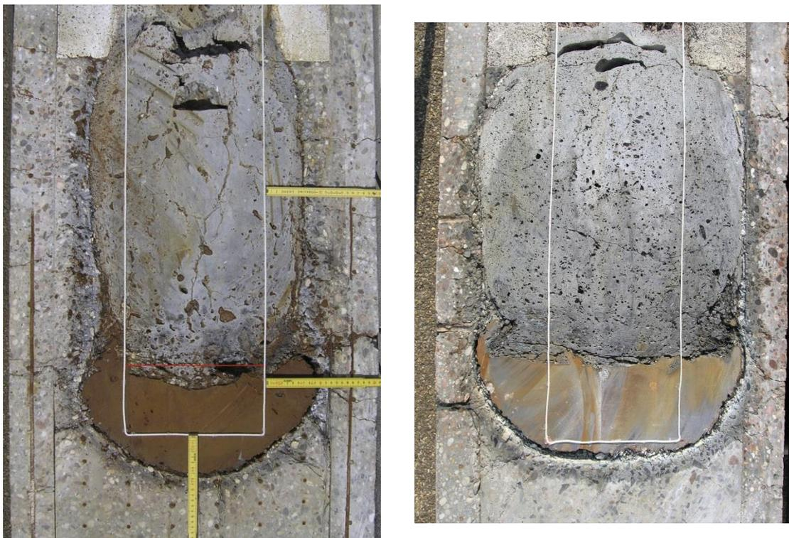
**Abb. 4.30** Gleichförmige Erosion in Versuchen mit silikatischem Beton und Bewehrung (linke Seite, MOCKA 3.1, /FOI 13/) und schwache Erosion am Boden mit LCS-Beton (rechte Seite, MOCKA 6.2, /FOI 14/)
