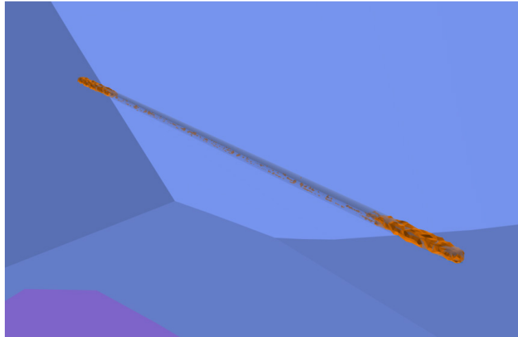
Abb. 5.23 10%-Isofläche der Porosität 60 Jahre nach Einlagerung
