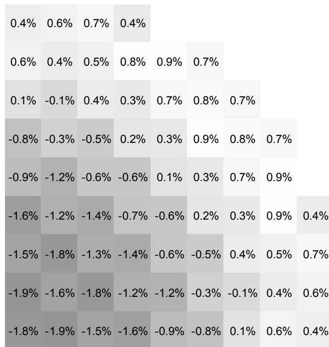
**Abb. 3.24** Abweichungen zwischen QUABOX/CUBBOX und KENO für den UOX-Kern im gestörten Kernzustand
