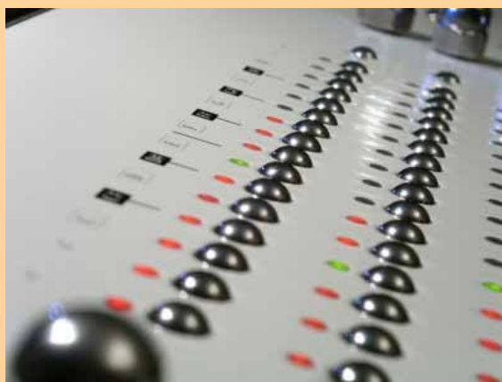
Ein Blick auf die Knöpfe der Stepmatrix: Es sind eingelagerte Metallkugeln.
