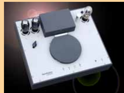
Die Dynastation ist ein ungewöhnlicher CD Player, der mit dem Laufwerk und den Wandlern aus der Playstation 1 läuft.
