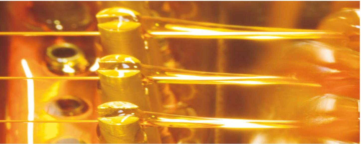
Die Auswahl des Lacksystems und die Herstellung der Lackdrähte werden bestimmt vom Anforderungsprofil, das von der Kundenseite aus gestellt wird. Da dieser Kunde seinerseits seinen Abnehmern die langfristige Gebrauchstauglichkeit seines Motors, Generators oder Transformators garantieren muss, ist eine gewisse konservative Grundhaltung und Forderung strenger Qualifizierungsprozeduren fast schon eine Selbstverständlichkeit.
