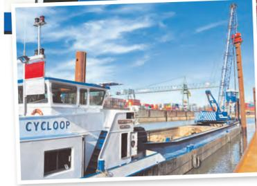
Spezialkonstruktion: Der Kran ist auf Schienen montiert und lässt sich leicht verschieben.
