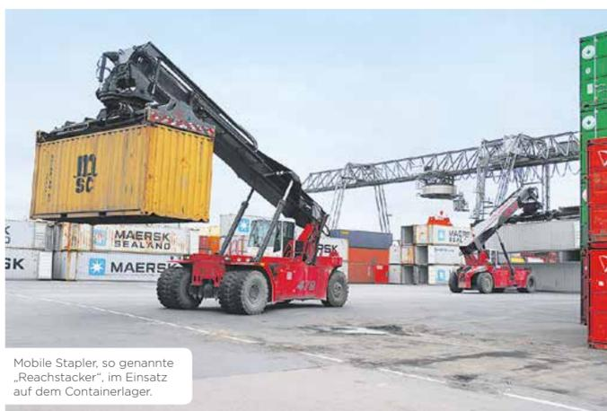
Mobile Stapler, so genannte „Reachstacker“, im Einsatz auf dem Containerlager.
