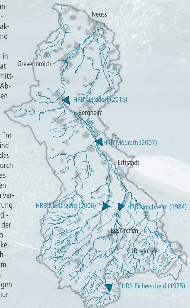
Verbund steuerbarer Becken für den Hochwasserrückhalt mit einem Rückhaltevolumen von insgesamt 5,24 Mio. m<sup>3</sup>
