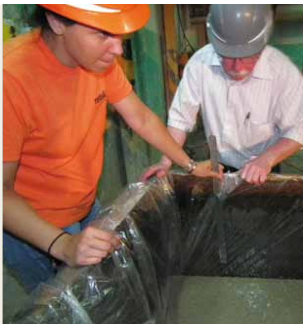
In dieser Wanne bilden sich die Gasblasen im Porenbeton Dr. Reinhard Röttenbacher mit Ardal-Mitarbeiterin
