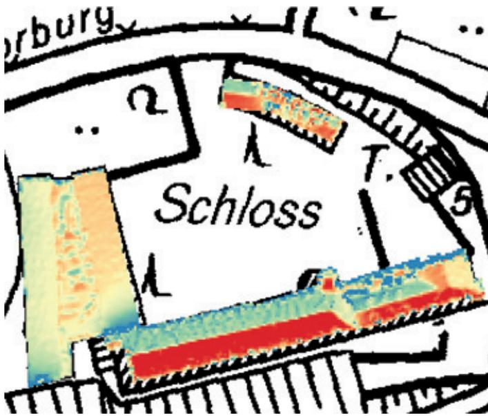
Mit Hilfe der Sonne kann theoretisch jeder Gebäudeeigentümer seinen eigenen Strom und Wärme produzieren. Die Produktivität von Photovoltaik- oder Solarthermieanlagen ist im Wesentlichen von der über das Jahr gesehen, einfallenden Sonnenstrahlung abhängig. Dabei spielen Ausrichtung und Neigungswinkel der Dachflächen,
