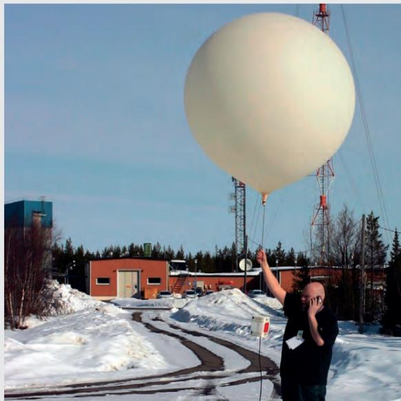
Vor jedem Raketenstart werden die Wetterverhältnisse geprüft. Unten am Ballon hängt ein Messgerät, das die Daten aus den verschiedenen Schichten der Atmosphäre an das Raumfahrtzentrum sendet. Vor allem starke Winde stehen dem Start zuweilen entgegen.
