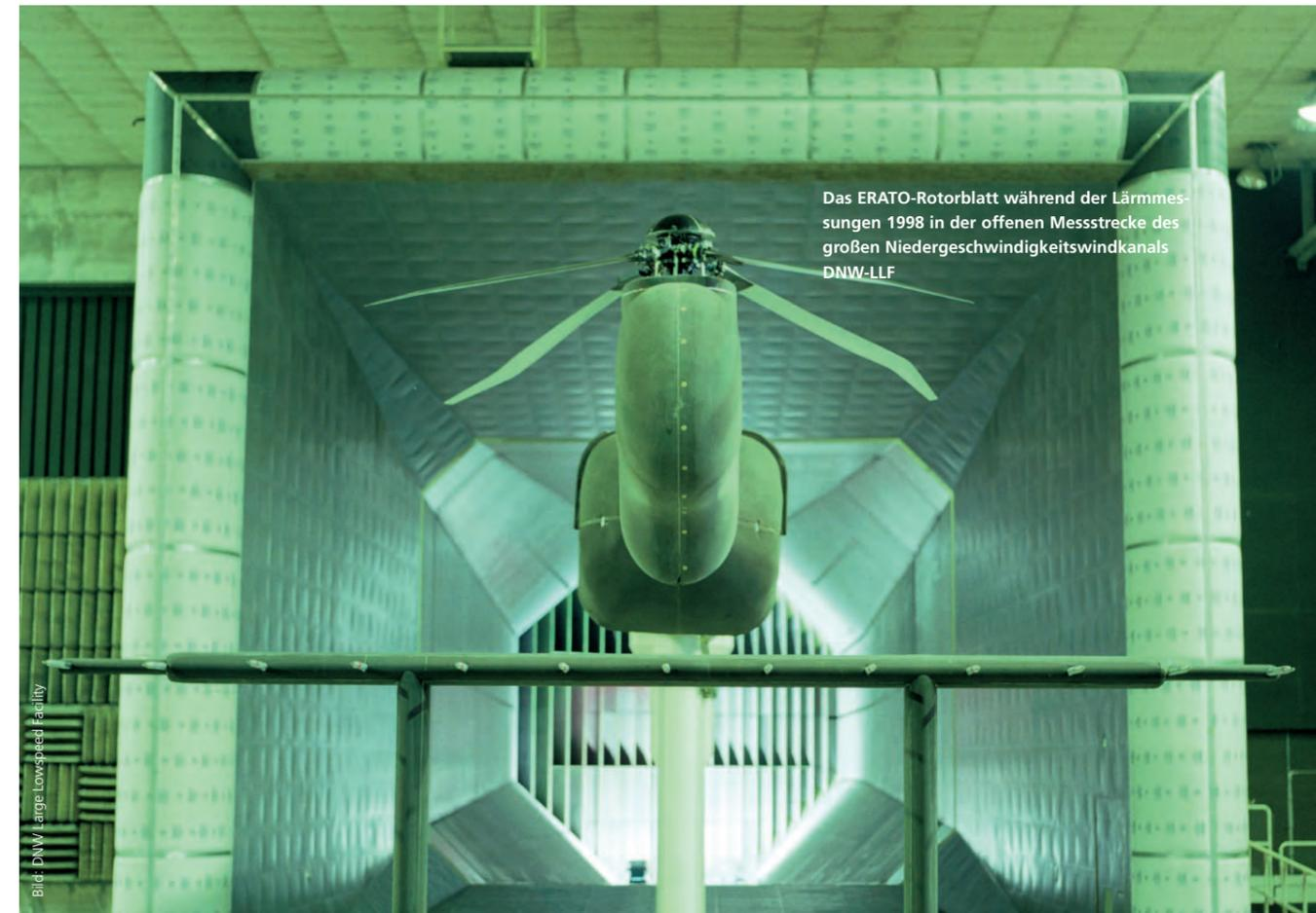
Das ERATO-Rotorblatt während der Lärmessungen 1998 in der offenen Messstrecke des großen Niedergeschwindigkeitswindkanals DNW-LLF
