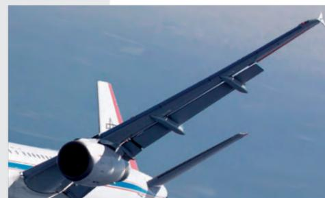
ATRA mit ausgefahrenen Landeklappen – typisch für den extremen Langsamflug
