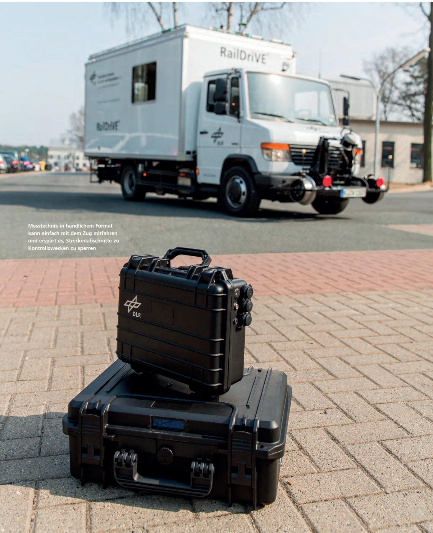
Messtechnik in handlichem Format kann einfach mit dem Zug mitfahren und erspart es, Streckenabschnitte zu Kontrollzwecken zu sperren
