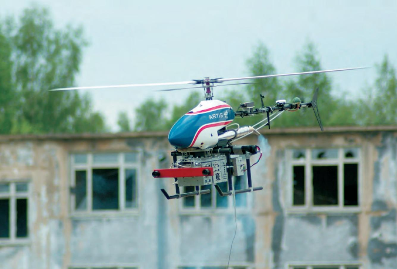
Der Flug von ARTIS wird ständig von einem Sicherheitspiloten am Boden überwacht. Er hat Sichtkontakt und kann im Notfall jederzeit die Kontrolle übernehmen. Die am Flugversuch beteiligten Forscher sitzen dabei in einer Art mobilem Büro und überwachen das Fluggerät am Monitor. Mit ihren Beobachtungen und den aufgezeichneten Daten wird ARTIS wieder ein Stück „intelligenter“.
