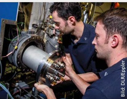
DLR-Wissenschaftler bauen den neu entwickelten Brenner in eine Versuchsanlage ein
