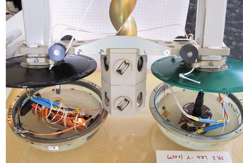
Das Instrument SESAME sitzt unter anderem in den Füßen des Landers Philae und misst mit akustischen Methoden die Beschaffenheit des Kometenbodens
