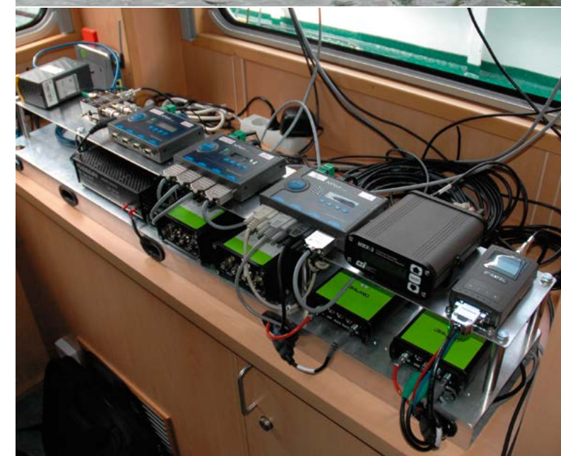
Zu der umfangreichen Messtechnik, die für den Test des Assistenzsystems auf dem Schiff installiert wurde, gehören auch diese Empfänger für die Daten des Global Navigation Satellite Systems (GNSS)
