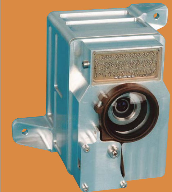
Die Kamera ROLIS an der Unterseite von Philae nimmt während der Landung auf Churyumov-Gerasimenko erste Bilder auf
