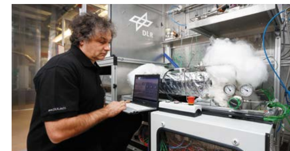
Der Wasserstofftank ist mit Feststoffen gefüllt, die das Gas wie ein Schwamm aufsaugen und so besser im Tank halten
