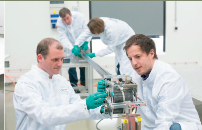
Ein ausgeklügelter Mechanismus soll in der Schwerelosigkeit den Mast entrollen. In der Bremer Integrationshalle testen die Wissenschaftler den reibungslosen Ablauf dieser Technik.
