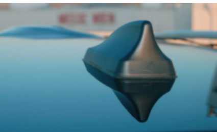
Prototyp einer Haifischflossen-Antenne für Satellitenkommunikation in Fahrzeugen
