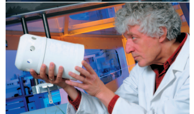
Wickelanlage zur Herstellung von Bauteilen aus Faserkeramik (oben) und Sichtprüfung eines Bauteils für Hochtemperaturanwendungen
