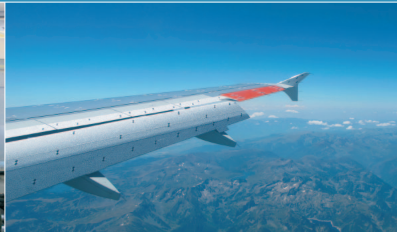
Steuerbordflügel mit Deformationsmarkern und speziellen Musterfolien bei einem Versuchsflug über den Pyrenäen
