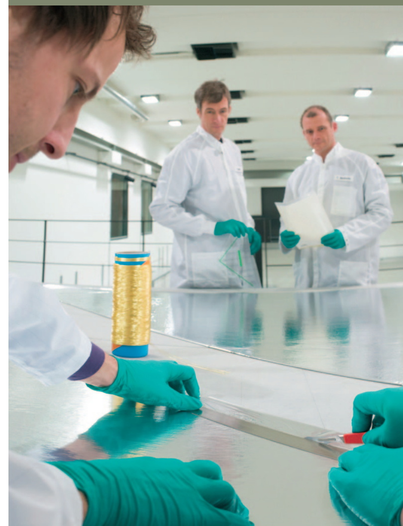
Auf dem Saugtisch schneidet und verklebt das Team die hauchzarte Folie zu maßgerechten Segeln. Ein Faden an der Außenkante sorgt anschließend dafür, dass die entfalten Segel die richtige Spannung haben.
