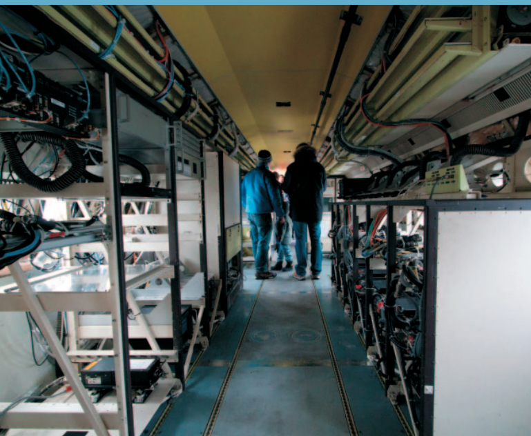
Die ATTAS-Kabine: Um Gewicht zu sparen, wurden für den Überführungsflug die Rechner ausgebaut
