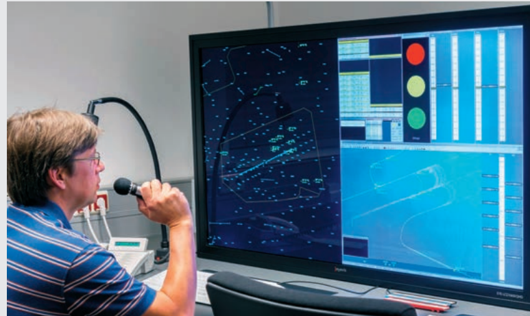
Weicht der Lotse vom Plan des Assistenzsystems ab, erkennt das System dies erst zeitverzögert über die eingehenden Radardaten. Den Sprechfunk zwischen Fluglotse und Cockpit im Assistenzsystem zu verarbeiten, könnte Abhilfe schaffen.
