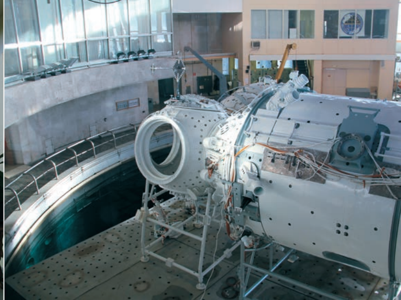
Tauchen für den Außenbordeinsatz: Sobald die Module ins Wasser abgesenkt werden, können die Astronauten trainieren, fast so schwerelos wie im All
