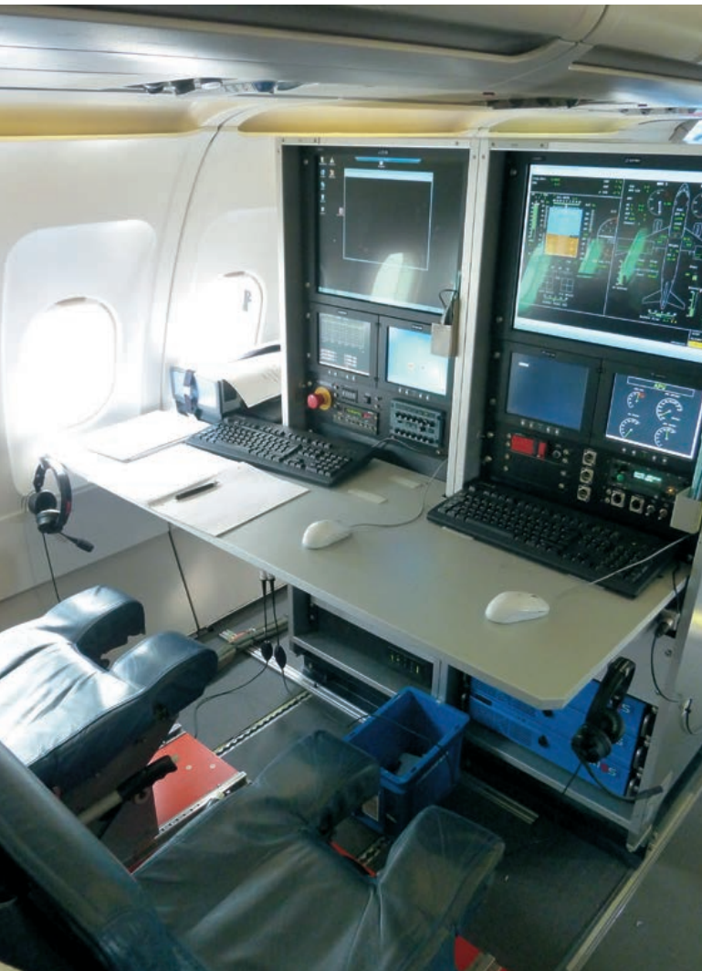
Die speziellen Arbeitsplätze zur Betreuung der Flugversuche in der Flugzeugkabine bieten Zugriff auf alle wichtigen Parameter und Flugzeugdaten, ähnlich wie im Cockpit für die Piloten
