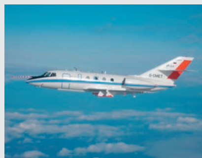
Die Falcon des DLR wird im Mai 2014 bei gemeinsamen Versuchsflügen mit der NASA zum Einsatz kommen. Geplant ist, Emissionen und die Veränderung von Kondensstreifen bei der Verwendung alternativer Treibstoffe im Flug zu vermessen.
