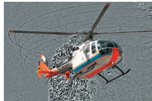
Die von den Rotorblattspitzen verursachten Luftwirbel sind vor passendem Hintergrund als dunkle Linien gut erkennbar. Versteht man die Lärm verursachenden Wirbel, kann man den Lärm mindern.
