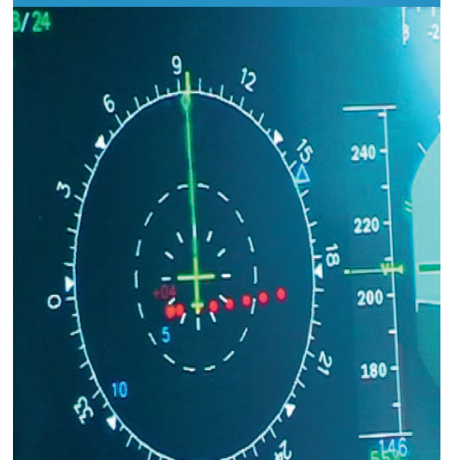
Piloten im Cockpit des DLR-Forschungsflugzeugs ATRA sehen auf einem Experimentaldisplay anhand der roten Markierung (Bild unten), wo sie mit Wirbelschleppen zu rechnen haben. Gezieltes Einfliegen in die Wirbel, welches sich beim Durchflug durch leichtes Rütteln des Flugzeugs bemerkbar macht, zeigt ihnen dann mit einem Blick auf den Vorhersagebildschirm: Das Warnsystem hat die Wirbel korrekt vorhergesagt.
