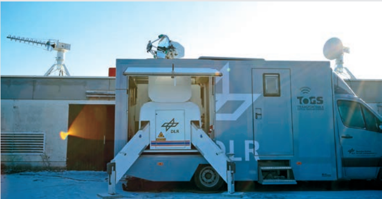
Die Transportable Optische Bodenstation TOGS des DLR-Instituts für Kommunikation und Navigation – aufgebaut neben dem Flughafen Ingolstadt/Manching
