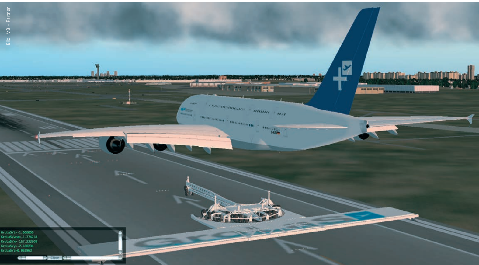
Fahrwerkloses Landen könnte zukünftig möglich sein. Eine Art rollender Schlitten koppelt an das um ein Fahrwerk erleichterte Flugzeug an (Ausschnitt aus einer Landesimulation).
