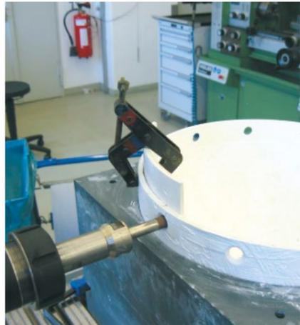
Die Halbschalen aus WHIPOX™ bei der Endbearbeitung im DLR-Institut für Bauweisen und Strukturtechnologie in Stuttgart
