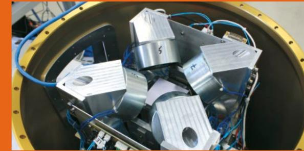
Experiment MEGraMA: Acht Magnete setzen wechselweise 2.500 kleine Kugeln in Bewegung, eine Kamera filmt, wie diese in Schwerelosigkeit wieder zur Ruhe kommen.
