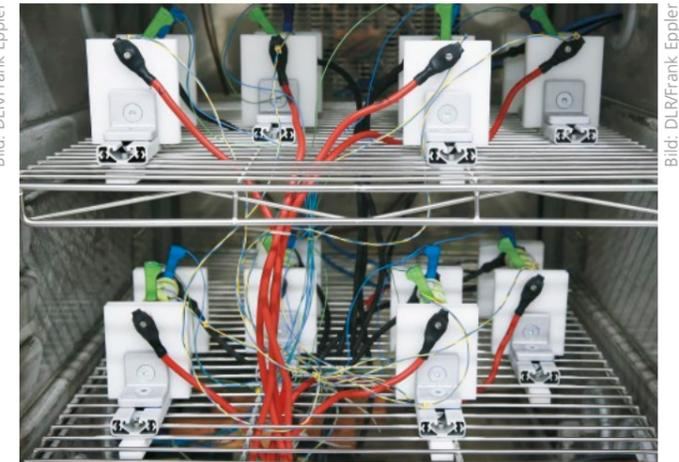
Batterien in der Klimakammer: Hier wird ihre Funktionsweise bei verschiedenen Temperaturen, von minus 40 bis plus 160 Grad Celsius untersucht.
