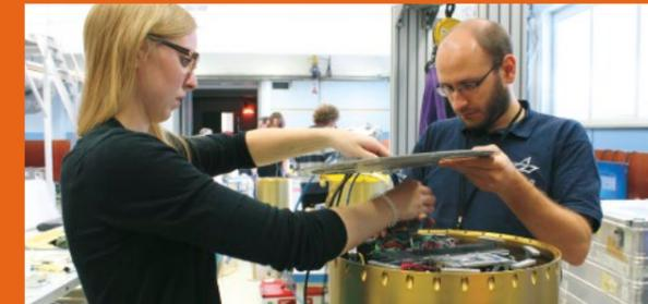
Experiment GOLD-ESL: Im Elektrostatischen Levitator werden Proben im Schwebezustand geschmolzen.
