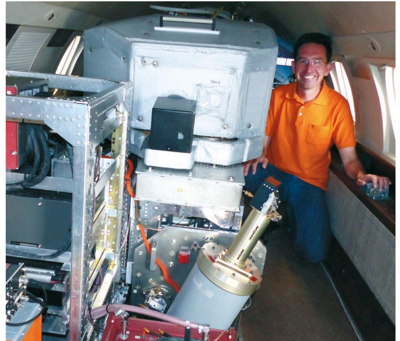
Blick in die Kabine der DLR-Falcon nach hinten mit den beiden Wind-Lidar-Instrumenten und dem DLR-Wissenschaftler Dr. Oliver Reitebuch vom Institut für Physik der Atmosphäre. Der optische Empfänger des Satelliten-Prototypen ALADIN ist zur thermischen Stabilisierung gut isoliert (graue Box, Bildmitte).
