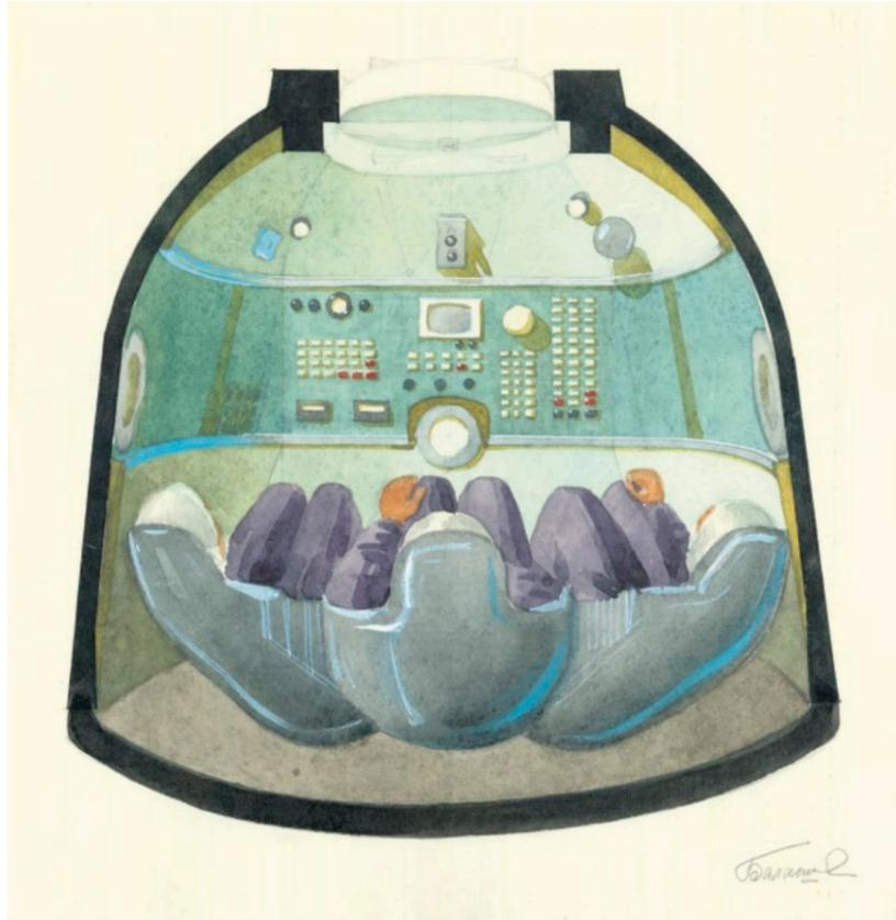
Entwurf für die Kommandozentrale des Raumschiffs Sojus mit den bis heute typischen Schalenstühlen
