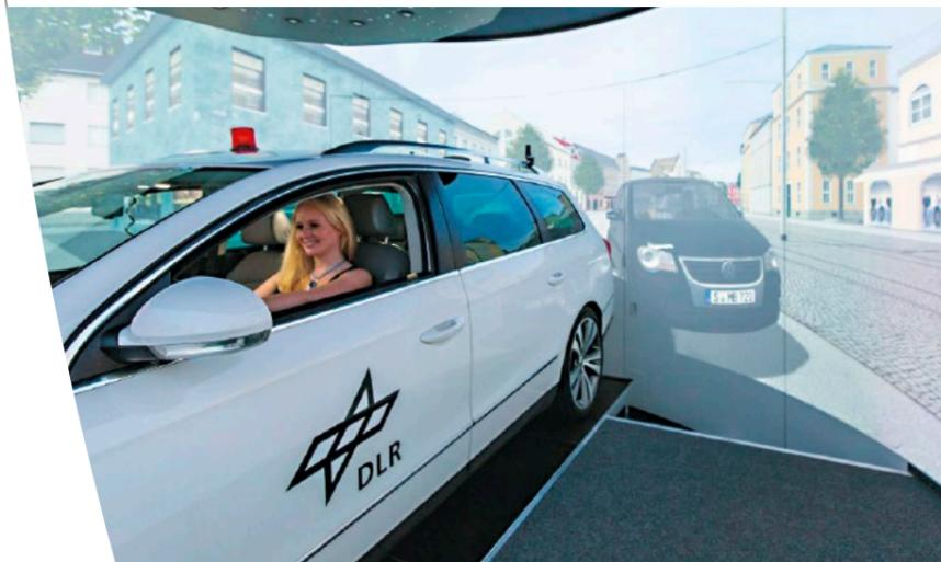
Das Virtual-Reality-Labor der Braunschweiger Verkehrsforscher verfügt über eine 360-Grad-Frontprojektion. In die Simulation lassen sich verschiedene Fahrzeuge und Mock-ups integrieren.
