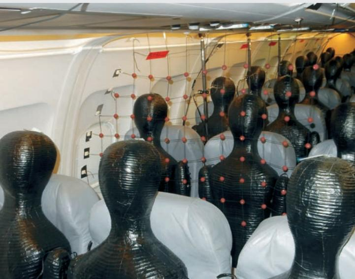
Die DLR-Wissenschaftler nutzen für die Kabinenforschung Dummies, die aus einem speziellen Hightech-Materialmix bestehen. Diese werden mit genau definierter Leistung beheizt. So erreichen sie eine sehr ähnliche thermische Signatur wie die von realen Menschen.
