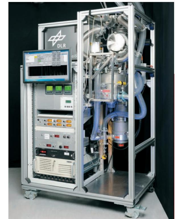
Das mobile Massenspektrometer – ein DLR-Eigenbau zur Abgasmessung und Analyse von Gasphasen bis hin zu Nanopartikeln
