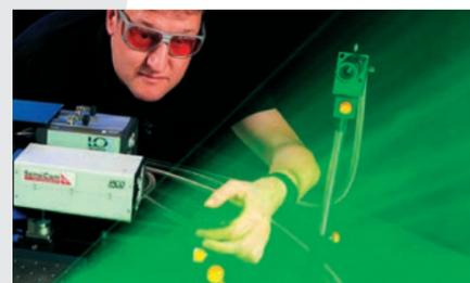
Laboraufbau der Messtechnik: Über eine Kristallfaser wird Laserlicht in die Austrittsebene der Brennkammer eingebracht. Über einen Bildleiter kann dann das Streulicht wie durch ein Schlüsselloch beobachtet werden.
