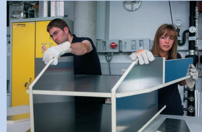
Auf Fingerfertigkeit und Sorgfalt kommt es an, wenn die einzelnen Bauteile zur Struktur des künftigen Fahrzeugprototyps zusammengefügt werden. Simon Brückmann und Lucia Areces stecken und kleben den Vorderwagen zusammen.
