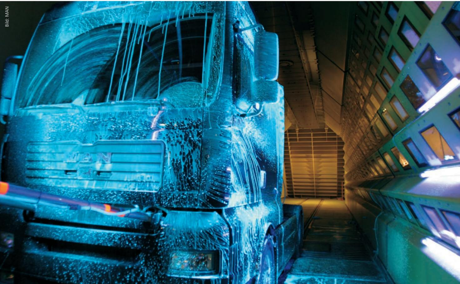
Ganze Lkw, Hubschrauber und sogar Züge können im Klima-Wind-Kanal (KWK) in Wien, dem modernsten Klima-Wind-Kanal der Welt, untersucht werden. Er ist Teil von Rail Tec Arsenal, einer international tätigen Prüfstelle für Klimatests an Schienen- und Straßenfahrzeugen. Den Kern dieses Prüfzentrums bilden zwei getrennte Klima-Wind-Kanäle, in denen unabhängig voneinander Fahrzeuge unter extremen Witterungsbedingungen getestet werden können.
