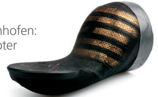
Die künstliche Haut auf der Struktur eines KUKA Leichtbauroboterarms
