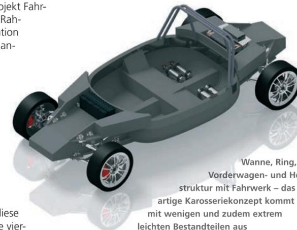
Wanne, Ring, Vorderwagen- und Heckstruktur mit Fahrwerk – das neuartige Karosseriekonzept kommt mit wenigen und zudem extrem leichten Bestandteilen aus
