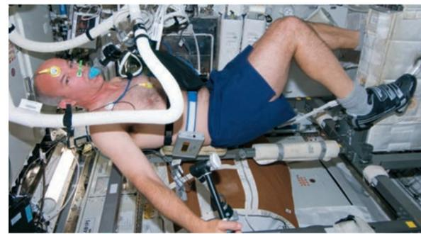
Thermo-Experiment auf der ISS im Jahr 2009: Zwei auf der Haut aufgeklebte Sensoren (gelb auf Kopf und Brust) maßen bei dem amerikanischen NASA-Astronauten Jeffrey Williams während eines leistungsphysiologischen Tests auf der ISS kontinuierlich die Körper-Kerntemperatur.
