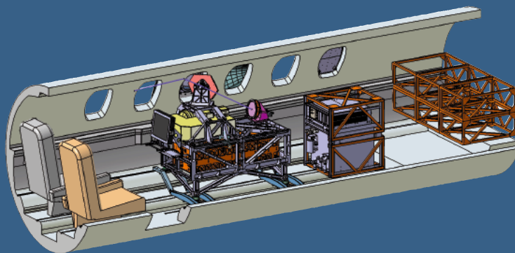
Eine CAD-Ansicht der DELICAT-Instrumentierung in der Kabine des Messflugzeugs: Das Flugzeug fliegt tatsächlich nach links. In der Mitte das Lidarsystem mit Laser-Transmitter (orange), Empfänger (gelb) und den nachgeführten Spiegeln, die den Laserstrahl durch das Kabinfenster führen.
