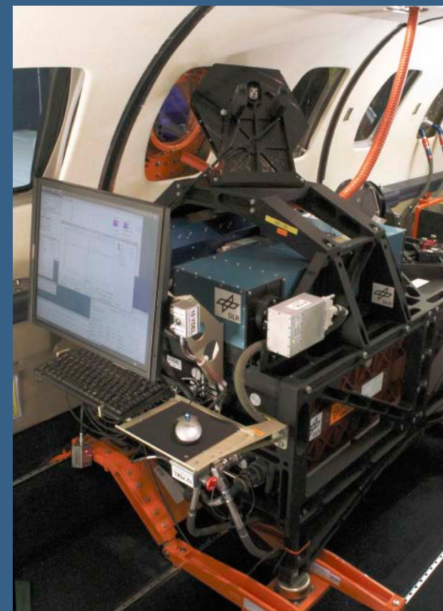
Das Lidarsystem aus dem DLR mit der Strahlführung von THALES im niederländischen Versuchsflugzeug PH-LAB
