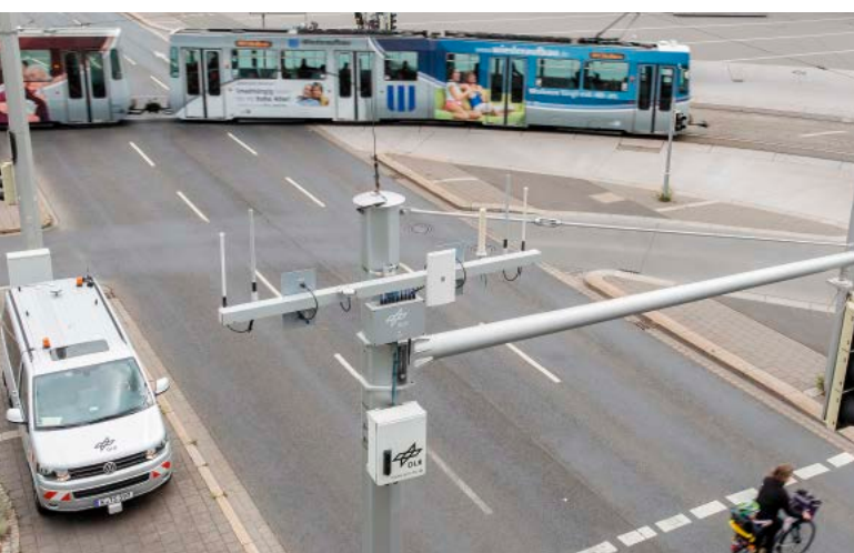
Auf der Referenzstrecke in Braunschweig testen DLR-Verkehrsforscher, wie Ampeln und Fahrzeuge miteinander kommunizieren können
