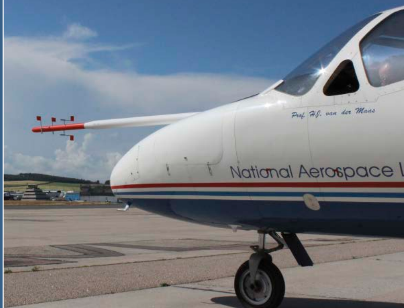
Die eingesetzte Cessna Citation 2, hier bei einer Zwischenlandung in Aberdeen. Der Nasenmast diente zur Messung des Schiebewinkels, da das Flugzeug in leichtem Seitengleitflug geflogen werden musste.
