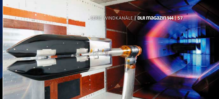
SERIE WINDKANÄLE | DLR magazin 144 | 57 Mit diesem Zugmodell aus kohlenstofffaserverstärktem Kunststoff messen die DLR-Wissenschaftler unter anderem den Lärm eines Hochgeschwindigkeitszuges
