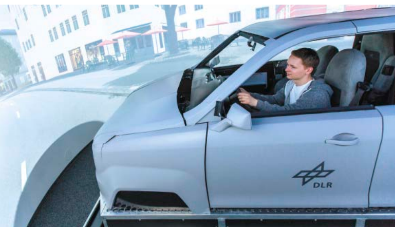
Mit dem Modulare Mockup lassen sich unterschiedliche Fahrzeugkonzepte untersuchen. Fahrzeugaufbau, Sitzanordnungen, Anzeigen und Bedienelemente können flexibel ausgelegt werden.
