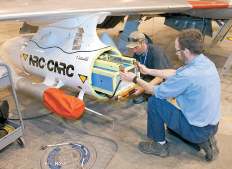
Der Sensor zum Vermessen der Wirbelschleppen wird in das kanadische Forschungsflugzeug T-33 eingebaut
