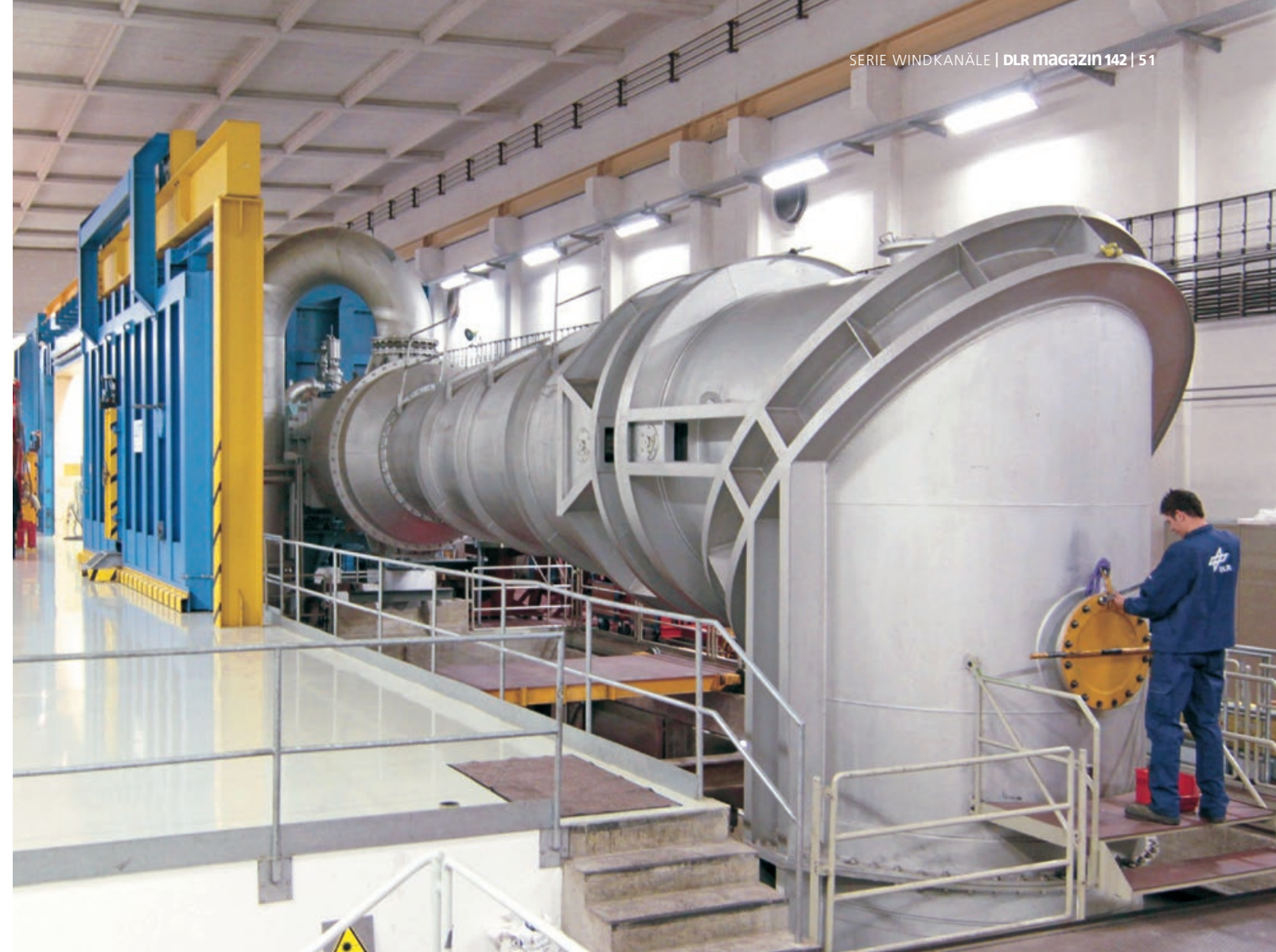
Der Transsonische Windkanal heute: 50 Meter lang und hunderte Tonnen schwer. Von den Anfängen der Airbus-Familie bis zum Eurofighter und A400M – in einem der bedeutendsten Windkanäle Deutschlands wird seit fünf Jahrzehnten für die Luftfahrt geforscht.
