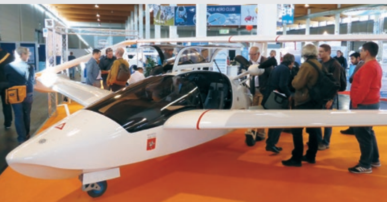
Das Prandtlplane eines italienischen Konsortiums überrascht mit Tragflügeln, die an ihren Enden miteinander verbunden sind. Zudem ist es wassertauglich.
