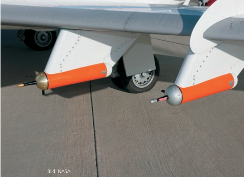
Rußpartikelsonden unter einer Tragfläche der DLR-Falcon
