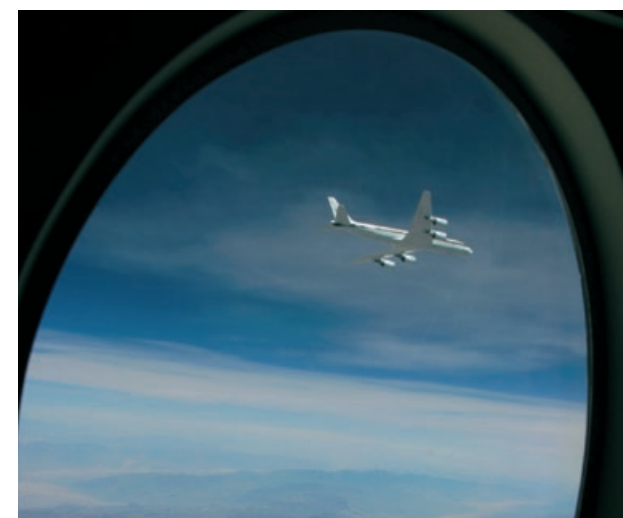
Aus dem Fenster der DLR-Falcon ist die DC-8 kurz zu sehen, bevor die Falcon sich hinter sie setzt, um deren Abgasstrahl zu vermessen
