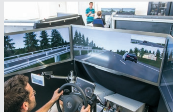
Das Simulationslabor MoSAIC des DLR verbindet mehrere Fahrsimulatoren miteinander. So können verschiedene Probanden gemeinsam in einer Simulationsumgebung fahren.
