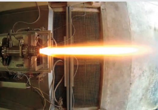
Das neue Hybrid-Triebwerk in der moder- nisierten Testanlage im DLR Trauen
