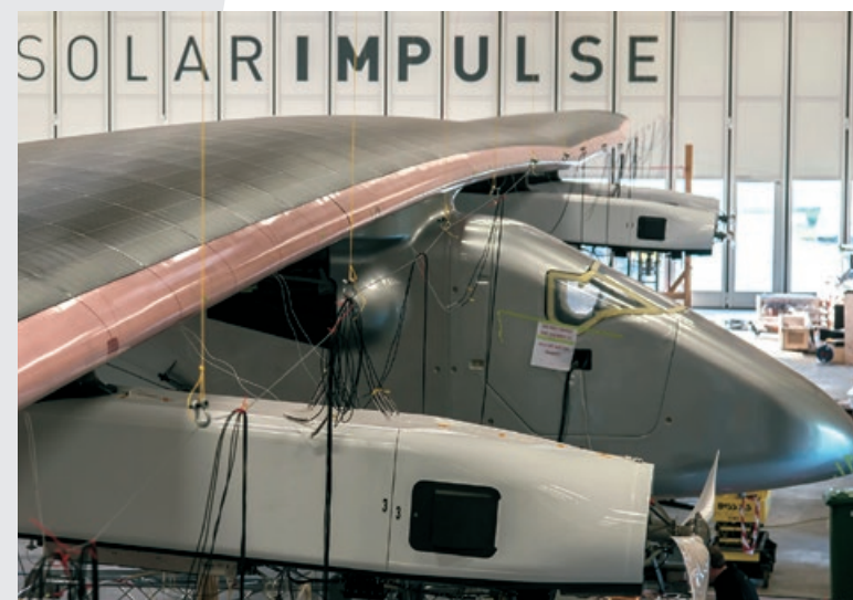
Der zweite SolarImpulse-Prototyp HB-SIB im Netz der DLR-Sensoren zur Schwingungsanalyse
