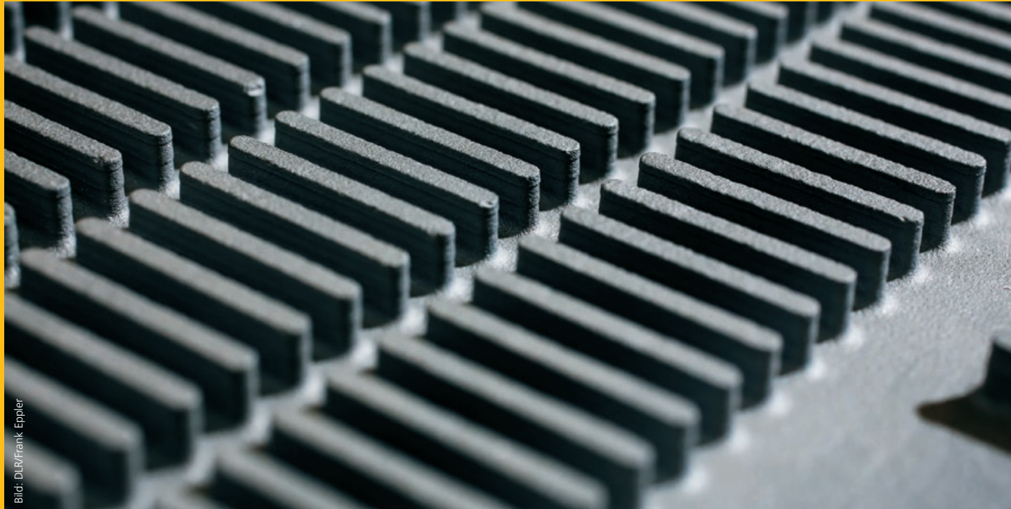
Komplexe und feine Strukturen sorgen beim Wärmetauscher aus biogener Keramik für eine große Oberfläche
