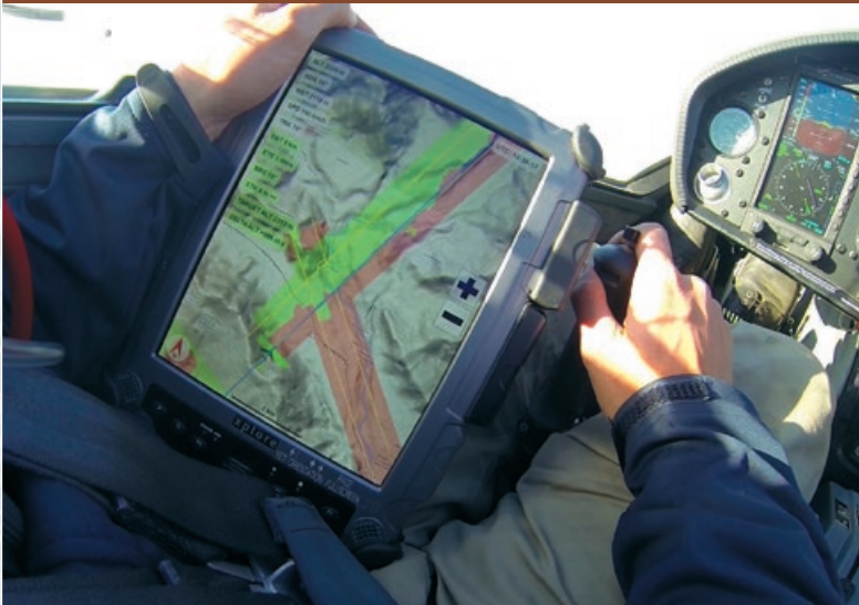
Das Flugführungssystem unterstützt die Piloten bei der systematischen Befliegung. Die grün markierten Flächen wurden befliegen und die erwarteten großen Helligkeitsunterschiede sind eingetreten.
