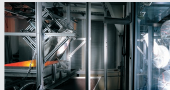
Neuartiger Receiver im Test mit Hochleistungsstrahlern am DLR-Sonnenofen in Köln
