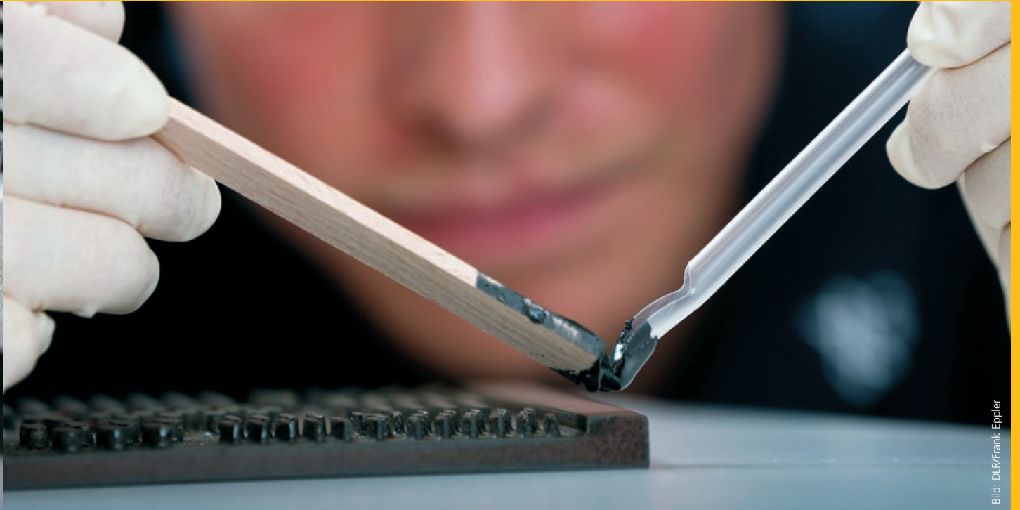
Mit einer speziellen Fügepaste lassen sich einzelne Elemente zu größeren Strukturen zusammenfügen
