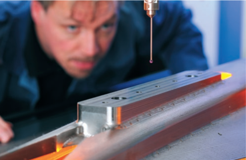
Erfolgskontrolle: Ein Windkanalmodell wird vermessen.
