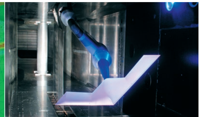
Modell eines unbemannten Nurflüglers. Am oberen Bildrand gut sichtbar ist die Aufhängung des Modells.
