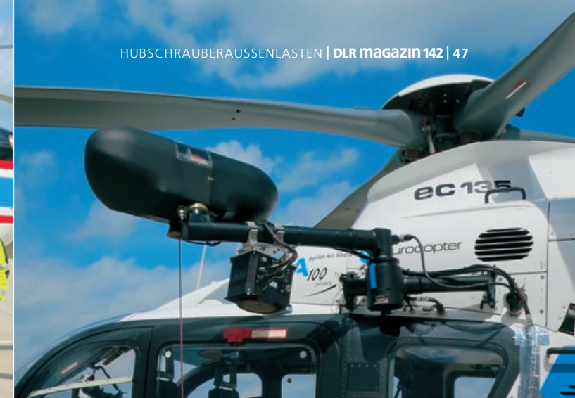
Der ACT/FHS mit Rettungswinde und angebaute Sensorik. Am Windenarm wurden ein optisch-inertialer Sensor-Adapter befestigt und oberhalb des Lasthakens ein aktiver Marker (LED-Licht) angebracht.
