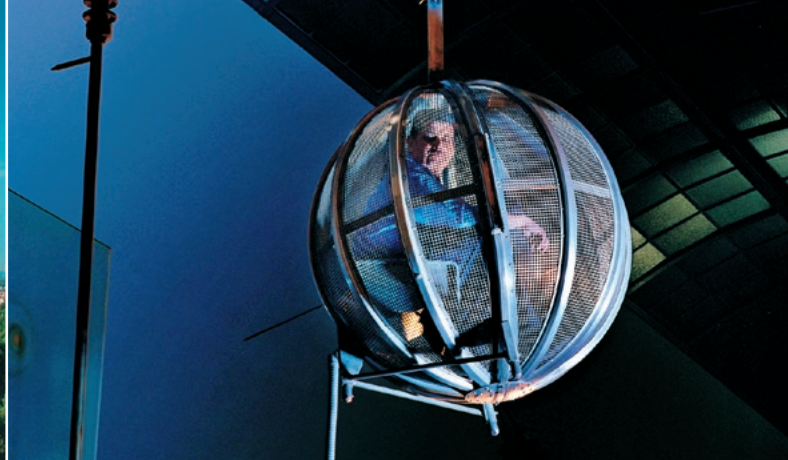
220.000 Volt und kein bisschen leise: Starkstromversuch mit dem Faradayschen Käfig
