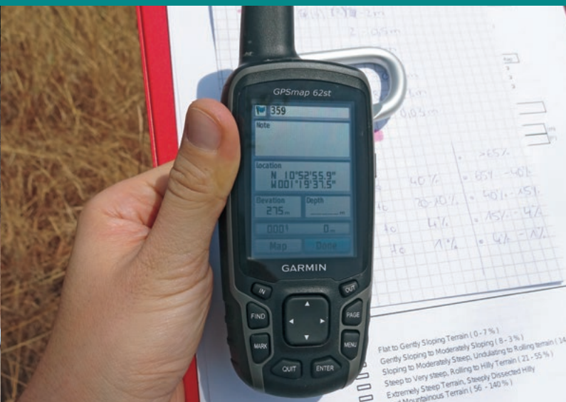
Die Aufnahmen vom Gelände werden mit Hilfe eines GPS-Geräts verortet, um sie später mit den Satellitendaten zusammenzufügen
