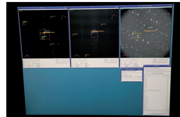
Mit Hilfe der Nachführkameras des Teleskops, der sogenannten Imager, wird das wissenschaftliche Ziel am Himmel angepeilt und im Fokus gehalten
