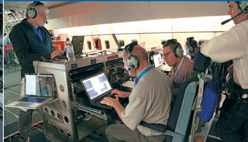
Während des Fluges werden die Daten von Teleskop und Instrument GREAT auf die Monitore der Wissenschaftler übertragen. Durch eine schnelle Vorab-Analyse kann die Beobachtung kontrolliert und gegebenenfalls korrigiert werden, um die wertvolle Forschungszeit so effizient wie möglich zu nutzen.
