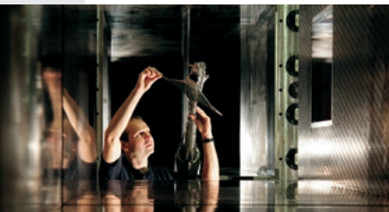
Techniker Andreas Grimme richtet das Modell des Versuchsflugzeugs X31 für den Test im Windkanal ein. Die Modelle müssen Winde bis zu doppelter Schallgeschwindigkeit aushalten.
