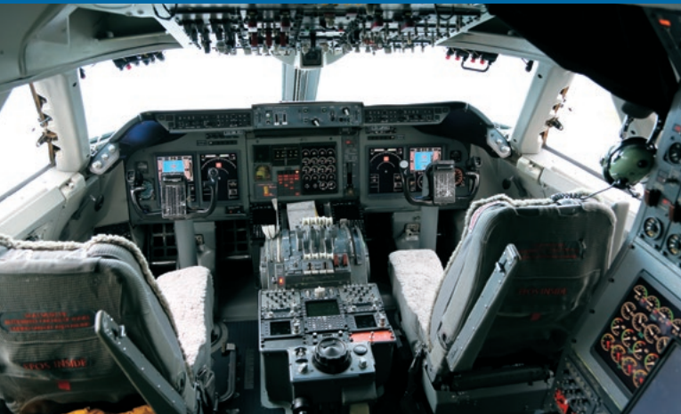
Eine umgebaute Boeing 747SP trägt das Infrarot-Observatorium in eine Höhe von rund 13.000 Metern. Im Jahr 2012 wurde das Cockpit des Flugzeugs modernisiert. An die Stelle der analogen Messgeräte traten moderne, digitale Instrumente.
