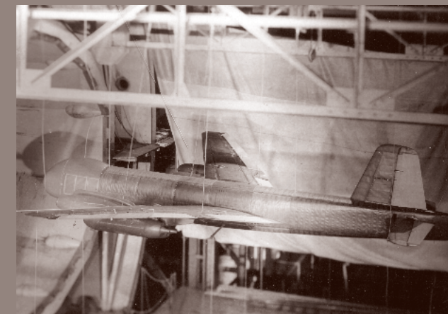
Das erste Flugzeug mit gepfeilten Flügeln: die Junkers 287 im Göttinger Windkanal
