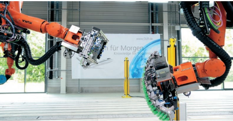
Mehr als nur Ablegen: In der Multifunktionalen Roboterzelle lassen sich unterschiedliche Prozesse in diversen Kombinationen erproben
