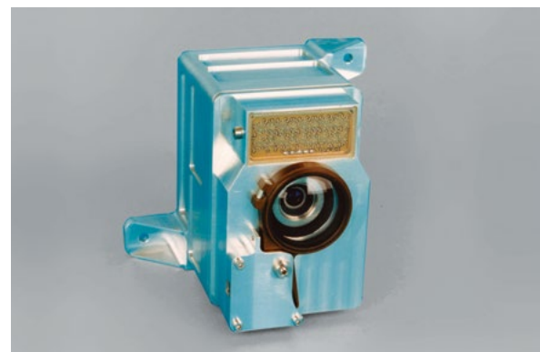
Die Kamera ROLIS am Lander Philae wird während der Landung Aufnahmen des Landeplatzes zur Erde senden
