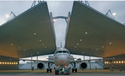
Für die Testläufe befindet sich das Forschungsflugzeug ATRA in einer Lärmschutzhalle der Lufthansatechnik auf dem Hamburger Flughafen
