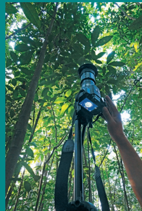
Mit einem speziellen Kamera-Objektiv fotografieren die Forscher die Baumkronen. So erfassen sie Dichte und Lichtdurchlässigkeit des Blätterdachs.
