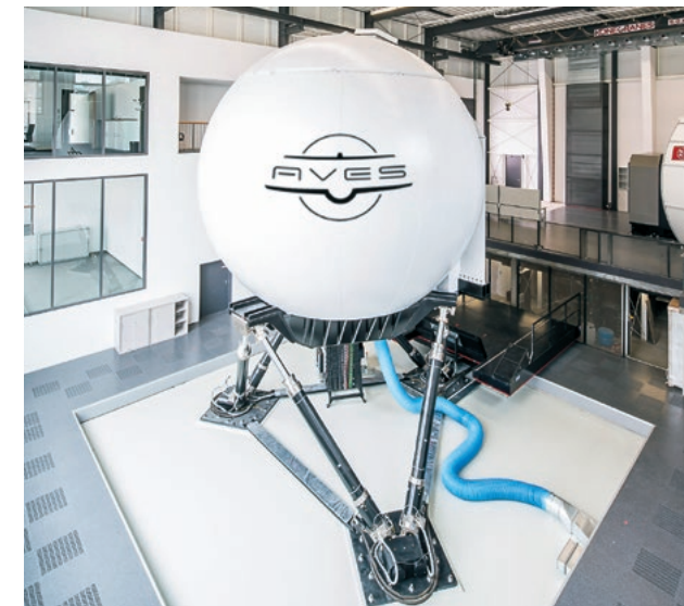
Blickfang in der Halle des Simulatorzentrums AVES ist der Full-Flight-Simulator, eine auf beweglichen Stelzen fixierte Kugelkonstruktion für die wahlweise Aufnahme des Airbus- oder des Helikopter-Cockpits
