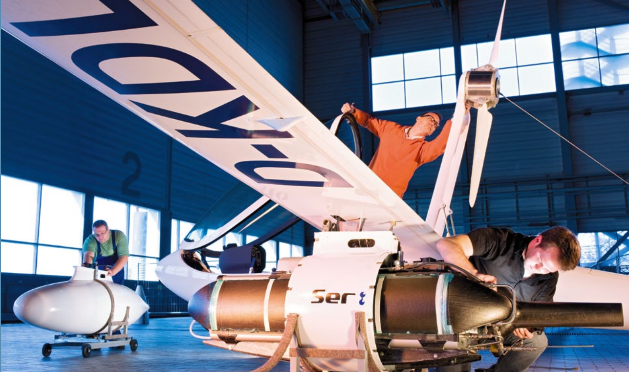
Der Hybridantrieb aus Batterie und Brennstoffzelle bewährt sich in der Luftfahrt: Beim Forschungsflugzeug Antares DLR-H2 unterstützt die Batterie beim Start, mit der Energiedichte des Wasserstoffs kann das Flugzeug lange Strecken zurücklegen
