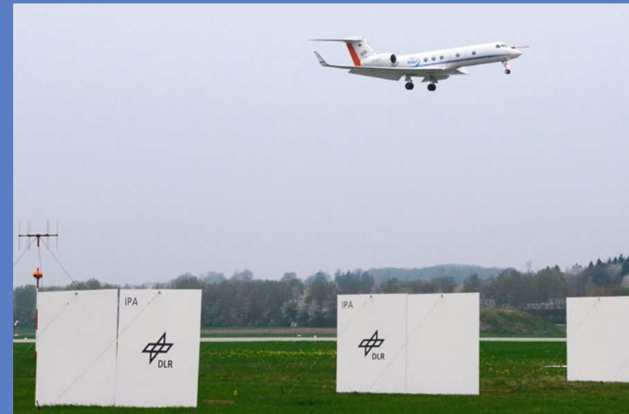
Etwa vier Meter breit sind die Platten, deren Sekundärwirbel die Wirbelschleppen schneller zerfallen lassen
