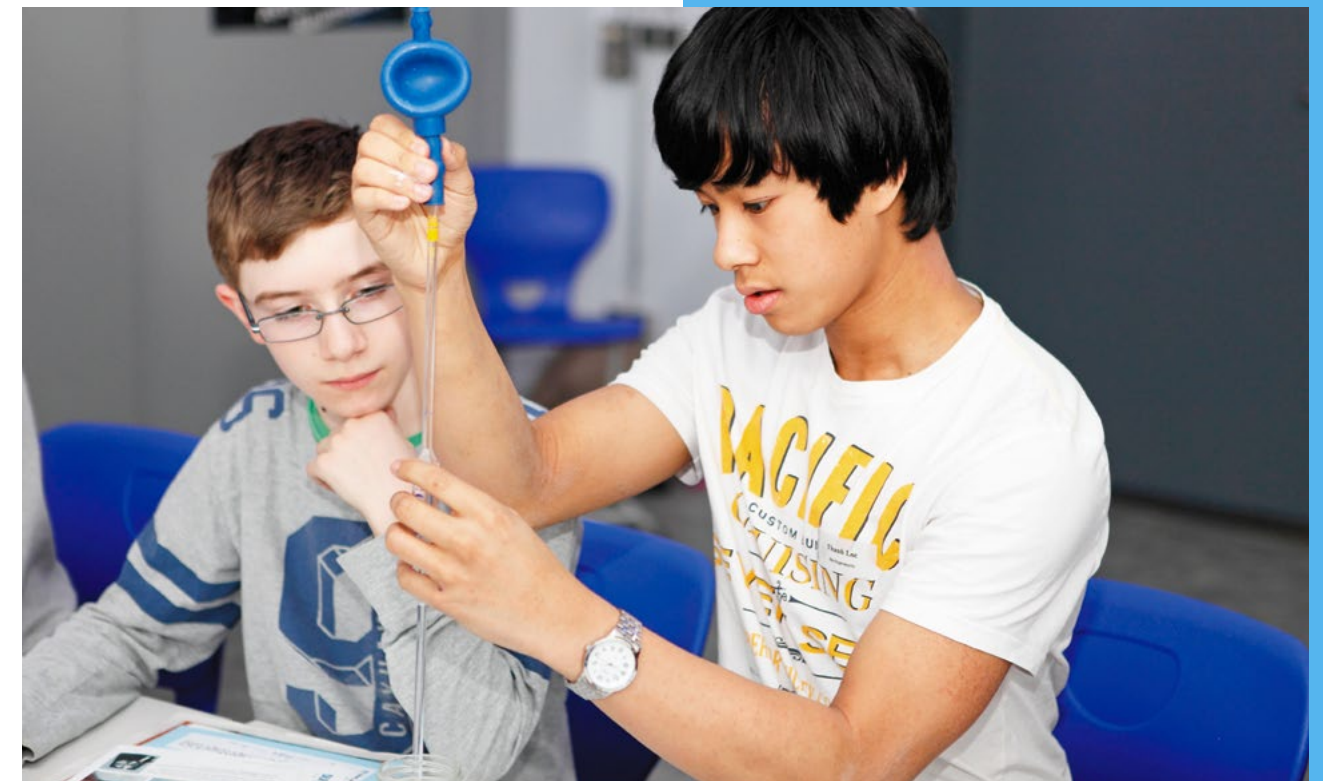
Dem Geheimnis der Grätzelzelle auf der Spur: Nguyen entnimmt ein paar Tropfen Titandioxidlösung, um sie auf kleine dünne Glasstreifen aufzutragen. Am Ende wird zwischen den verbundenen Glsträgern ein Stromfluss nachgewiesen.
