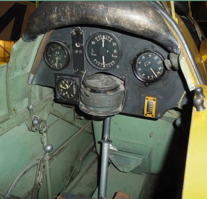
Spartanisch ausgerüstetes Cockpit der de Havilland „Tiger Moth“, charakteristisch vor allem der horizontal installierte Flug-Kompass. Das Foto rechts zeigt die historische Tafel mit den – noch handschriftlich eingetragenen – Abflugzeiten vom 20. August 1931.
