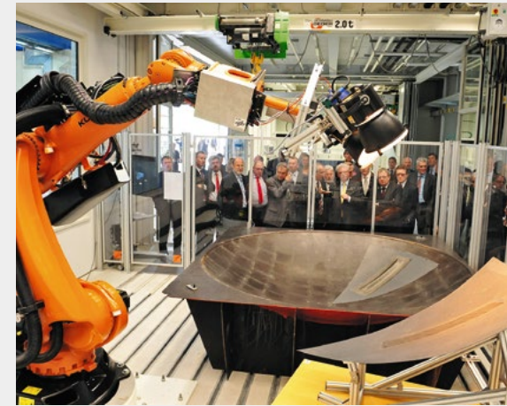
Der Roboter mit Legekopf verfügt über eine besonders große Reichweite zum Greifen und Ablegen der Thermoplast-Zuschnitte
