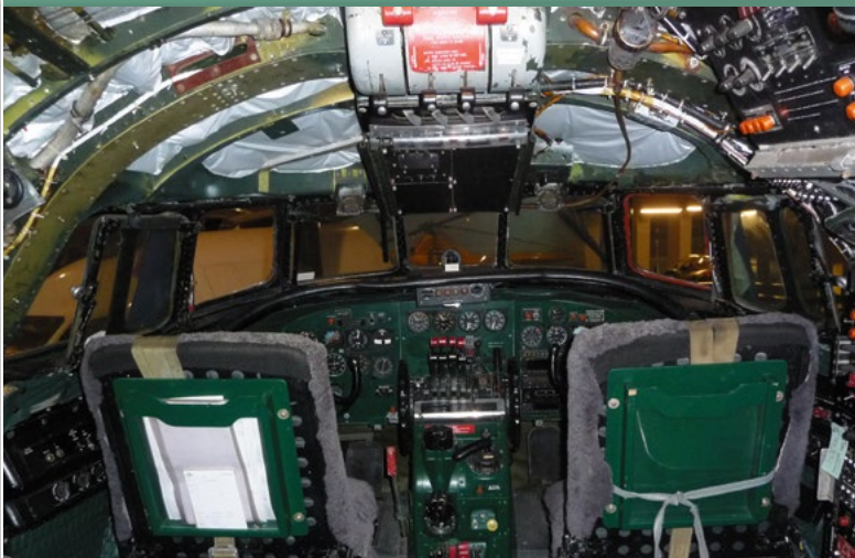
Blick in das Cockpit des viermotorigen Langstreckenverkehrsflugzeugs Lockheed L 749 „Constellation“, eines Vorläufers der später weltweit populär gewordenen „Super Connie“. Eine Vielzahl von analogen Rundinstrumenten beherrscht das Bild, rechts erkennt man noch den Arbeitsplatz des Flugingenieurs.
