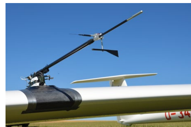
Verschiedenste Messprojekte werden von den studentischen Segelfliegern durchgeführt. Fäden und Kameras auf einer Tragfläche dokumentieren Strömungsablösungen (oben). Eine Sonde auf dem Flugzeugflügel dient zur Vermessung des Anströmwinkels (unten).
