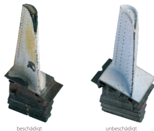
Die weiße keramische Wärmedämmschicht ist bei der linken Schaufel nach vielen Langstreckenflügen teilweise abgeplatzt
