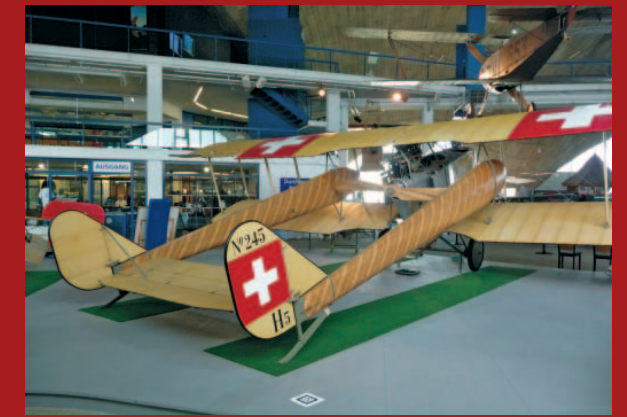
Der Schweizer Flugzeugkonstrukteur August Häfeli entwickelte zwischen 1915 und 1929 diverse zweisitzige Doppeldecker-Kampfflugzeuge, darunter dieses Modell DH1-H5 mit einem bemerkenswerten zweifachen Seitenleitwerksträger
