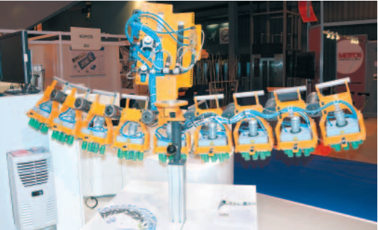
Der „Streifengreifer“ kann Bauteile aus kohlenstofffaserverstärktem Kunststoff sicher handhaben, ein wichtiges Qualitätsmerkmal für die Produktion der Leichtbauteile
