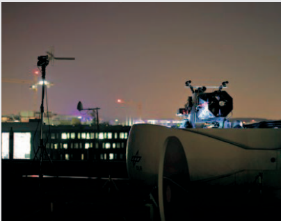
Vom Flugzeug gesendetes Laserlicht wurde von der DLR-Bodenstation empfangen, mit speziell entwickelten Messgeräten aufgenommen und analysiert
