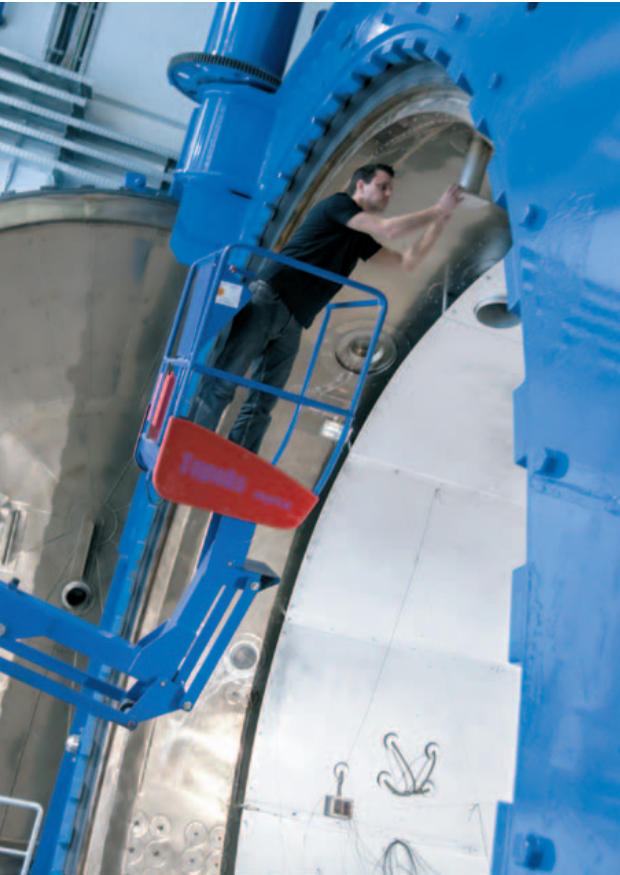
Jens Bölke guckt in die Röhre: Im oberen Bereich des Autoklaven soll eine Infrarotkamera die Temperaturverteilung während des Prozesses aufnehmen
