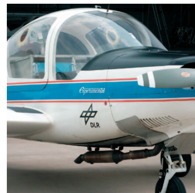
Das großzügig verglaste Cockpit bietet beste Sicht. Die Öffnungen in den Seitenscheiben geben den Messgeräten den direkten Blick auf den Laminarhandschuh frei.
