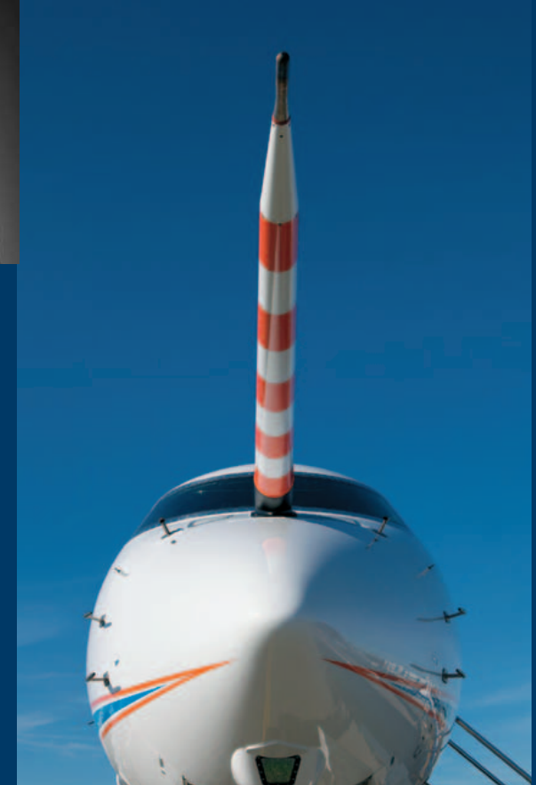
Mittels Nasenmasten ermitteln die Forscher heute wie damals aufs Genaueste die Windschwankungen (Turbulenz) vor den Forschungsflugzeugen HALO (2011; oben) und Falcon (etwa 1978; unten)
