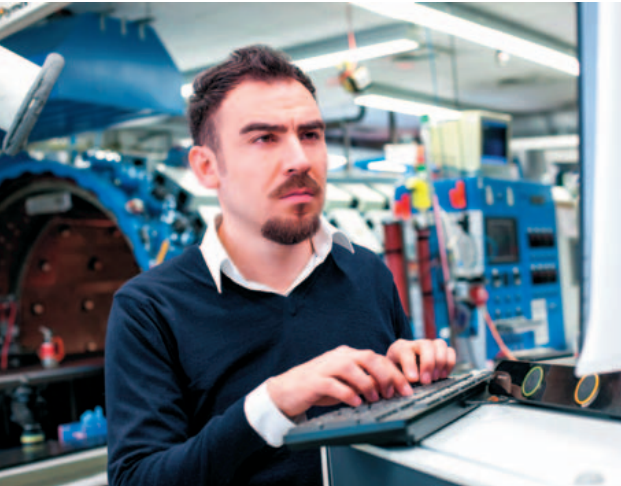
Alles auf dem Screen: Hakan Uçan entwickelt die dynamische Autoklavsteuerung. Sie wird den Prozess des Aushärtens von Bauteilen aus CFK im Autoklaven optimieren.
