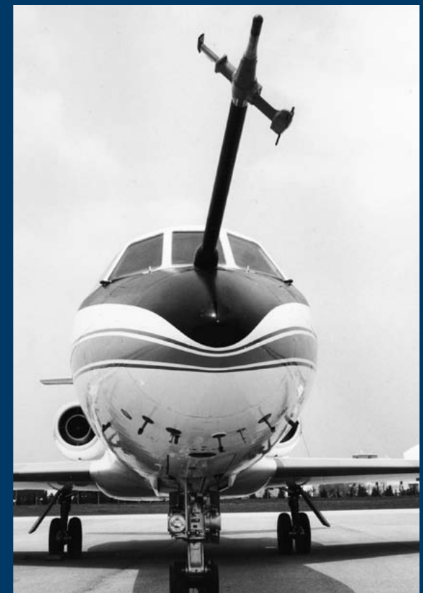
Mittels Nasenmasten ermitteln die Forscher heute wie damals aufs Genaueste die Windschwankungen (Turbulenz) vor den Forschungsflugzeugen HALO (2011; oben) und Falcon (etwa 1978; unten)
