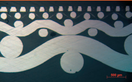
Was den Anschein einer Borte hat, ist die Schliffprobe einer hybriden Außenhaut-Bauweise. Obere Lage: perforierte Außenhaut, darunter der Gewebeverbund. Diese Bauweise bietet die Möglichkeit, Luft der Grenzschicht abzusaugen.
