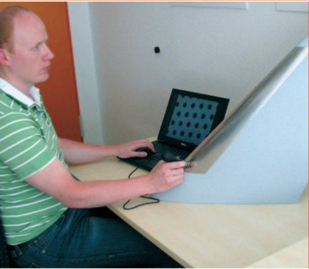
Bild links: Matthias Horn vermisst an seinem Arbeitsplatz im DLR-Institut für Bauweisen- und Konstruktionsforschung in Stuttgart die Mikroperforation eines Seitenleitwerkmodells Bild oben: das Ergebnis einer Strömungsrechnung, die Auskunft gibt über die Wandreibung am Seitenleitwerk. In Blau zu erkennen die niedrige Wandreibung in laminarer Umströmung.
