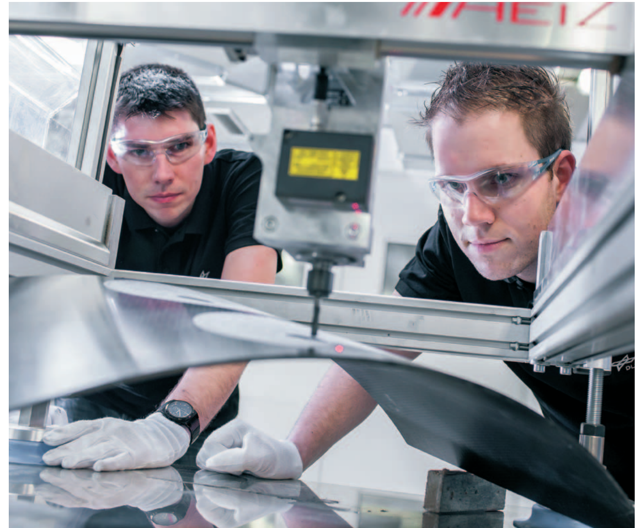
Dirk Holzhüter (links) und Alexander Pototzky, Student der TU-Braunschweig, bei der Arbeit: Im DLR-Labor testen sie die neuartige Reparaturanlage für Flugzeugbauteile aus Kunststoff auf Herz und Nieren
