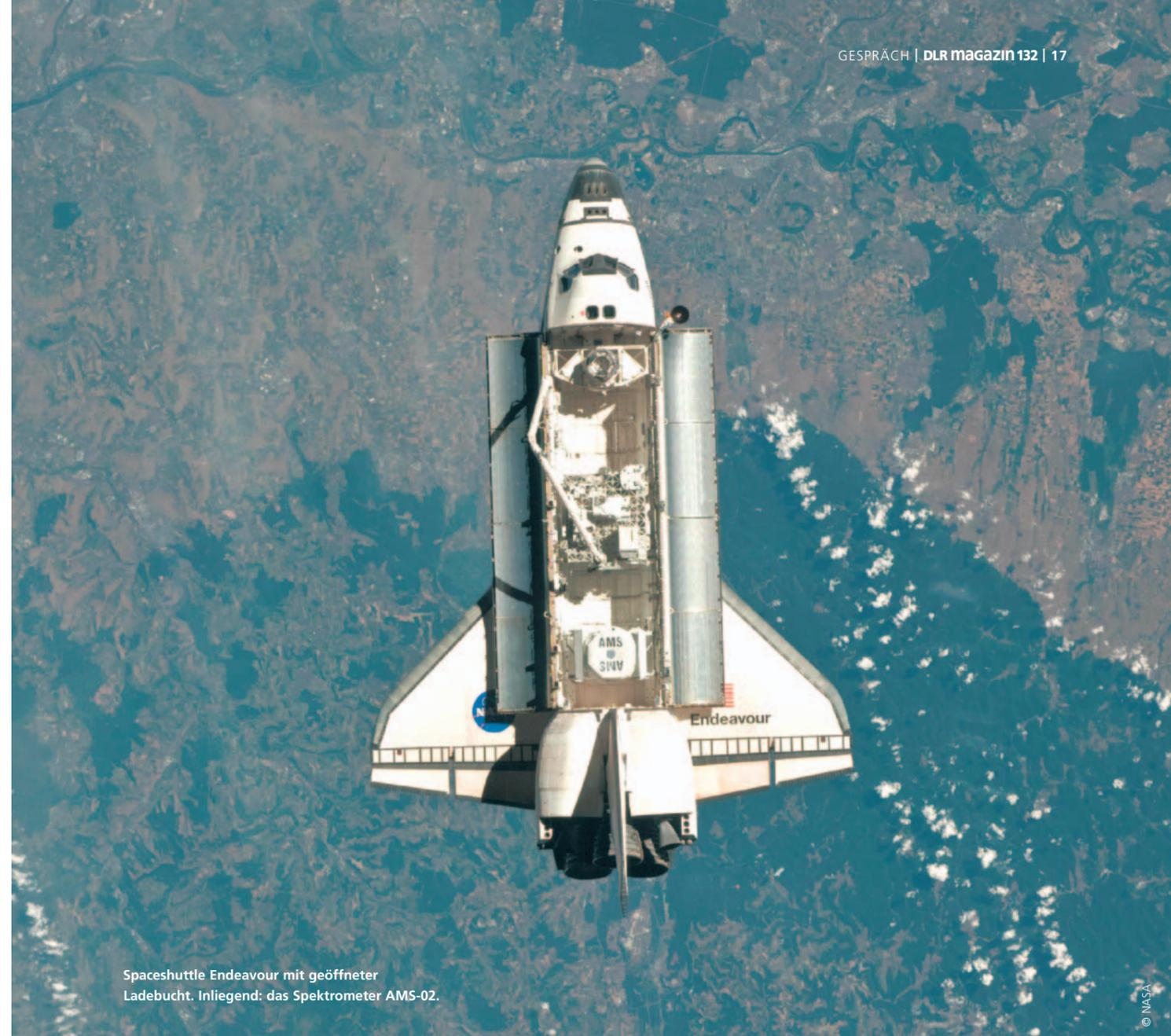
Space Shuttle Endeavour mit geöffneter Ladebucht. Inliegend: das Spektrometer AMS-02.
