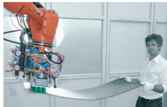
Großflächige Zuschnitte können nicht mehr sinnvoll automatisiert von einem einzelnen Roboter mit Greifer gehandhabt werden. Die dafür benötigten Einzelgreifer sind sehr schwer, weisen große Abmessungen auf und sind unhandlich.
