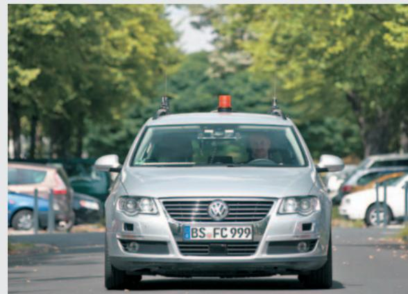
Das DLR-Versuchsfahrzeug FASCar „spricht“ mit den Ampeln
