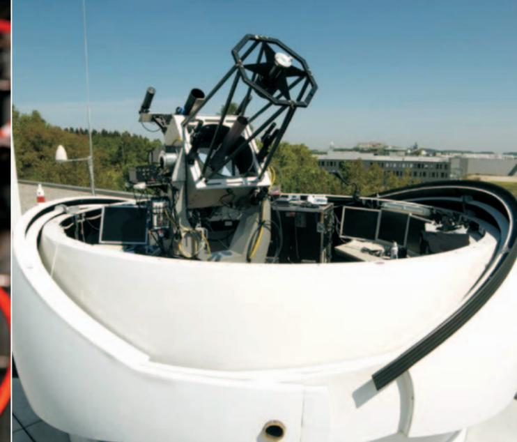
Optische Bodenstation Oberpfaffenhofen. Hinter dem Teleskop ist eine optische Bank angeflanscht, welche den Kommunikationsempfänger und die Messgeräte beherbergt.
