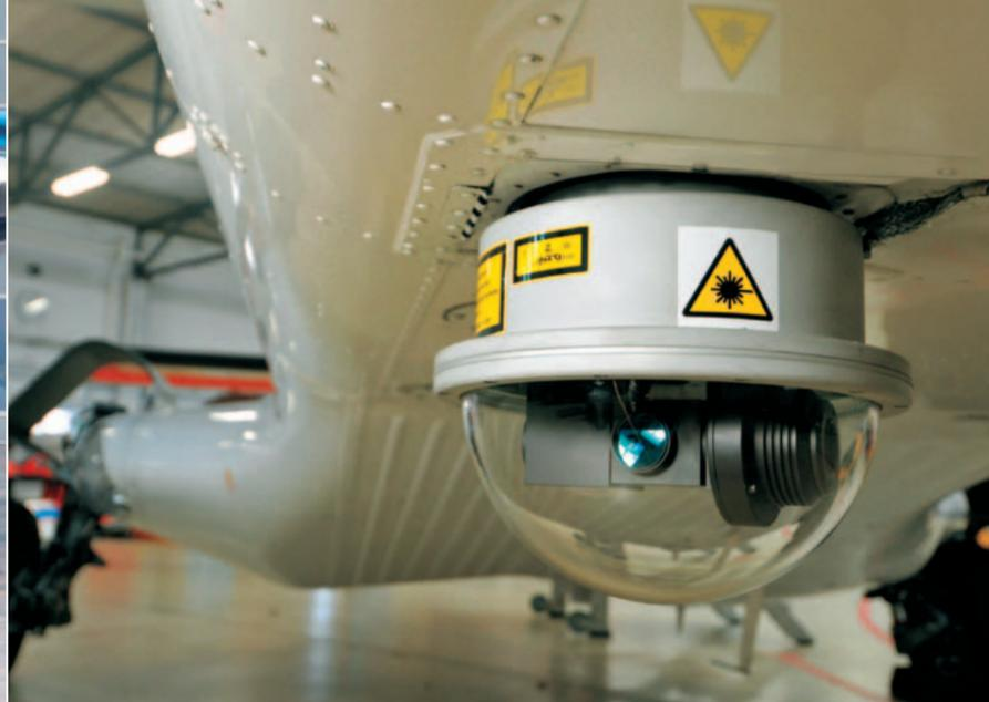
Außenbau der Sendeeinheit. Der Sendestrahl tritt aus der Linse aus und kann in den gesamten unteren Halbraum gelenkt werden.
