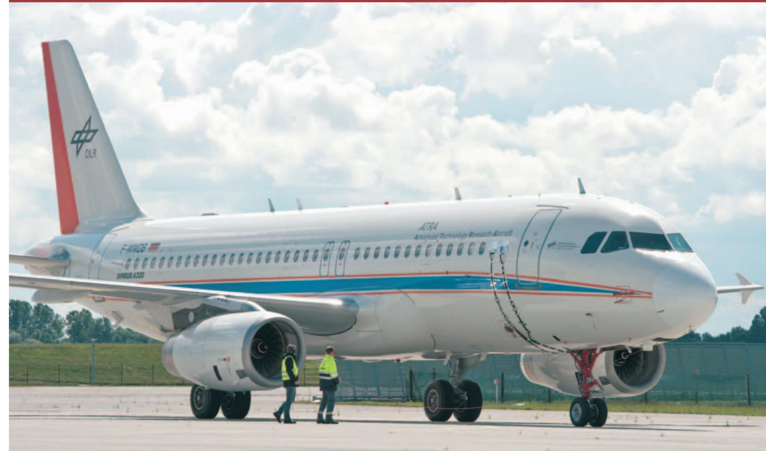
Leise und ohne Abgase zur Startbahn: Der Airbus A320 ATRA bei den Bugradtests im Juli 2011 in Hamburg
