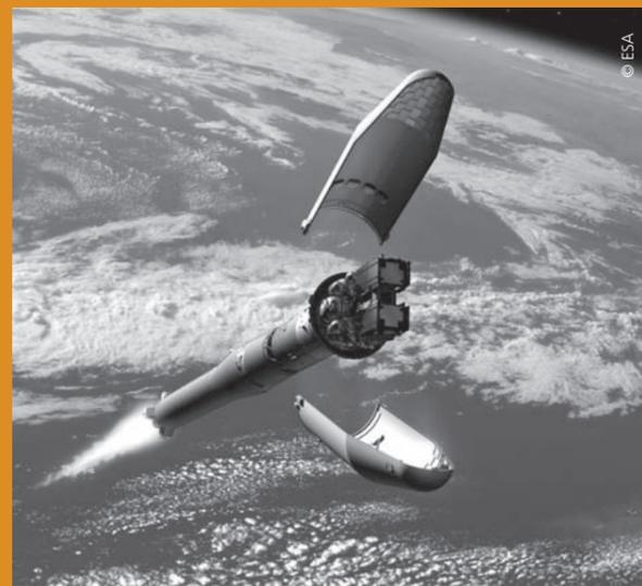
Nach Absprennen der Nutzlastverkleidung wird die kostbare Fracht sichtbar: die Galileo Satelliten
