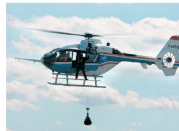
Bei Flugversuchen mit dem DLR-Forschungshubschrauber (FHS) wurde unter anderem die an den FHS angebaute Rettungswinde überprüft
