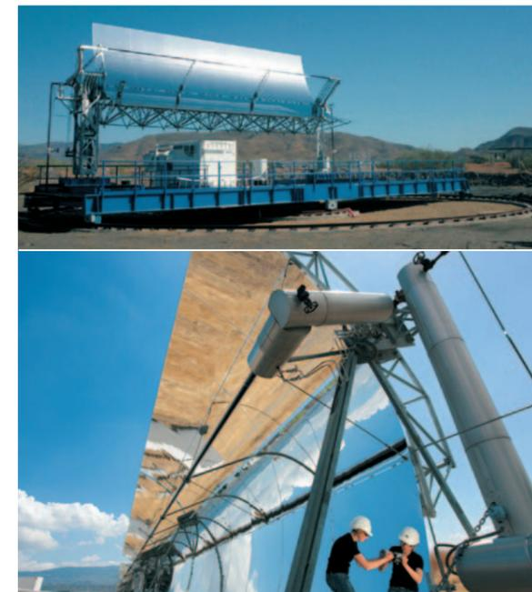
Oben: Drehbarer Prüfstand Kontas auf der Plataforma Solar de Almería
