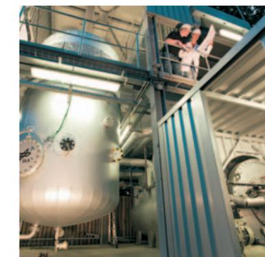
Kern der Versuchsanlage „HOTREG“ beim Institut für Technische Thermodynamik ist ein fünf Meter hoher Speicherbehälter. Mit dem variablen Teststand zur Untersuchung von Wärmespeichern können die Wissenschaftler unterschiedliche Speicherkonzepte, Betriebsweisen und Materialien erproben.
