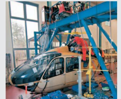
An einem Hubschrauber vom Typ EC 135 werden im Flug auftretende Rotorschwingungen simuliert. Dazu ist er in dieser Versuchsanordnung am Rotorkopf fixiert.
