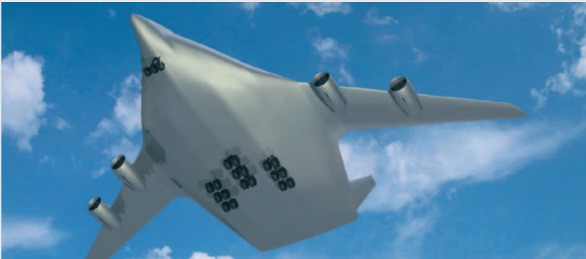
So könnte das Passagierflugzeug der Zukunft aussehen: Die vom DLR-Forschungsflugzeug ATTAS jetzt im Flug simulierte Nurflügelkonfiguration
