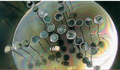
Teller mit den Probenträgern für das Mondgestein-Simulat JSC-1 – Aufnahme nach der Pyrolyse der Proben
