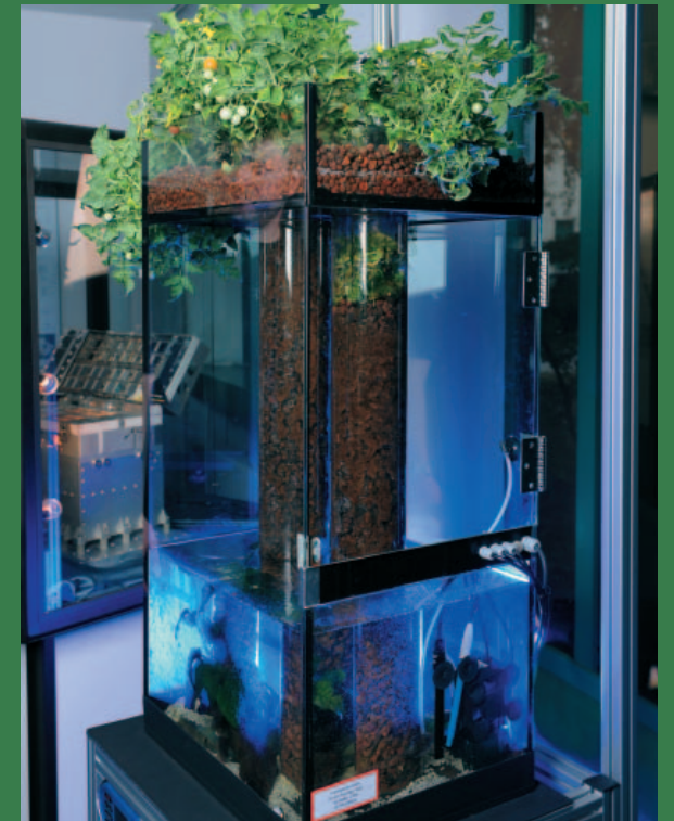
Das Kernstück des Lebenserhaltungssystems C.R.O.P. sind die beiden mit Lavasteinchen gefüllten Röhren. In ihnen fressen Bakterien die Abfälle. Das Produkt des Stoffwechsels sind wertvolle Nährstoffe für Pflanzen.
