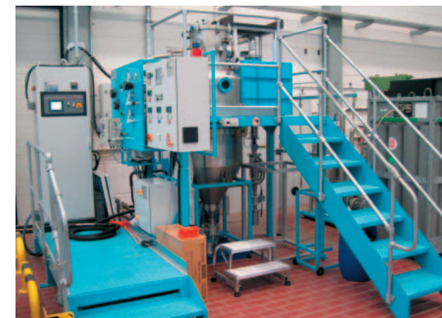
Anlage zur Verdüsung von Materialien: Hier entwickeln DLR-Forscher die Prozesse zur Herstellung thermoelektrischer Pulver
