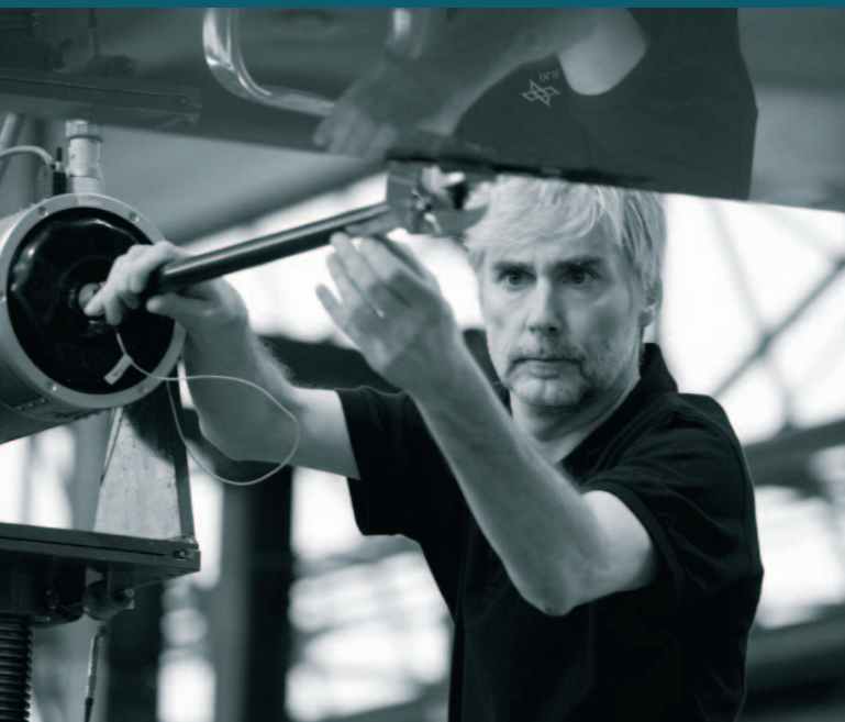
Anbringen eines Schwingungserregers
