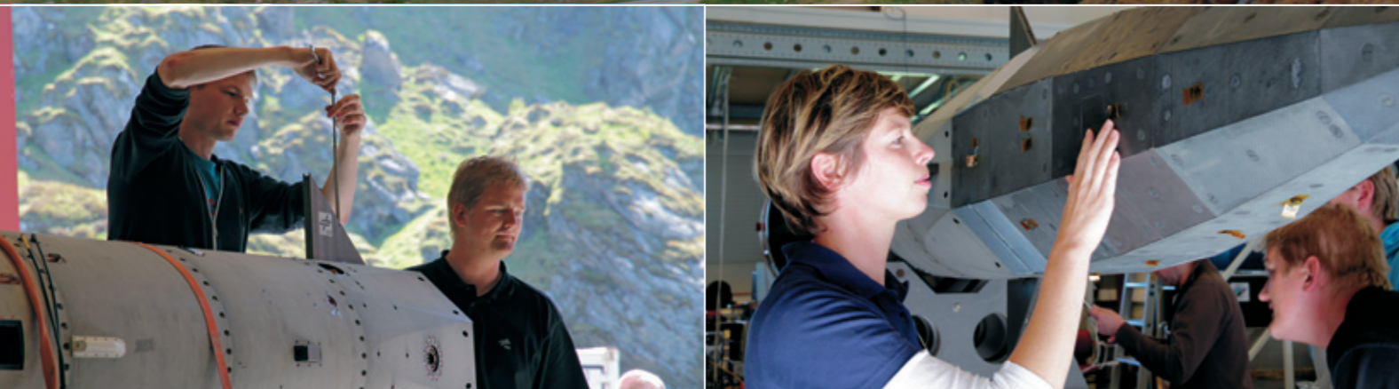
Bevor sich Shefex II in den Himmel über dem Andøya Raketttskytefeld erhebt, werden die kleinen „Flügel“ sorgfältig ausgerichtet und die Hitzeschutzkacheln noch einmal gestreichelt
