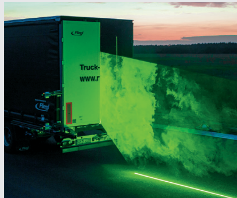
Laser und Rauch machen die Strömungen hinter einem 40-Tonnen-Sattelzug sichtbar
