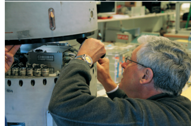
Millimetergenau muss Shefex II montiert werden. John Turner von der Mobilien Raketenbasis des DLR achtet auf Verkabelung, Messinstrumente und Verschlussringe.
