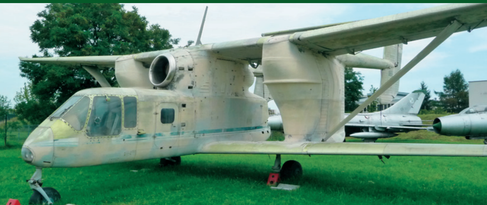
Eine wirkliche Rarität ist die PZL M-15 „Belfegor“, das weltweit einzige Landwirtschaftsflugzeug mit Strahltrieb. Der voluminöse Tragflügelhalter diente zugleich als Behälter für das Sprühmittel.
