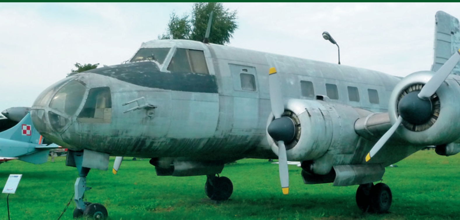
Prototyp der MD 12 F, einer polnischen Eigenentwicklung eines photogrammetrischen Messflugzeugs
