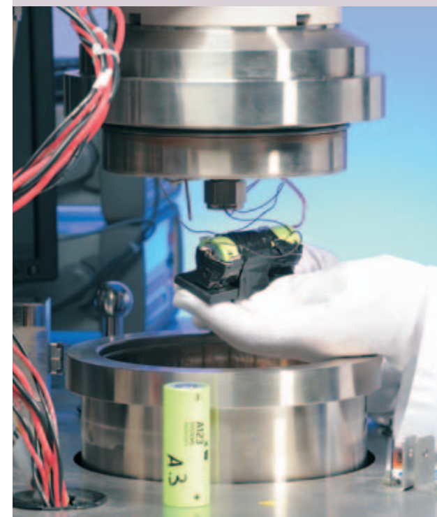
Hochleistungszellen werden in das Batteriekalorimeter eingebaut, um ihr thermisches Verhalten zu untersuchen
