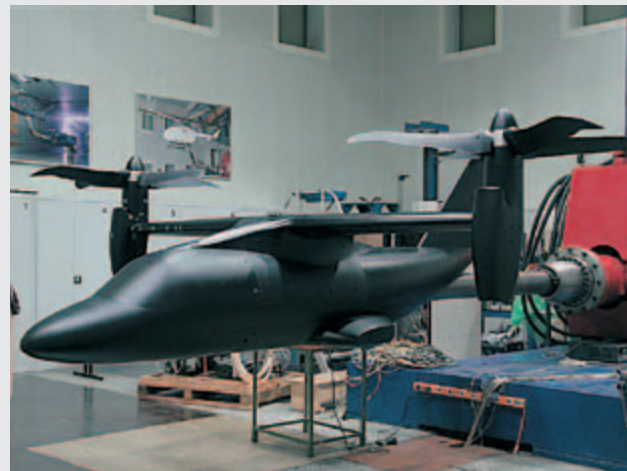
Das Bild zeigt das Windkanalmodell des Kipprotor-Flugzeugs mit den unterschiedlichen Einstellungen der Rotoren: Für den Start sind die Rotoren wie bei einem Hubschrauber nach oben gestellt.
