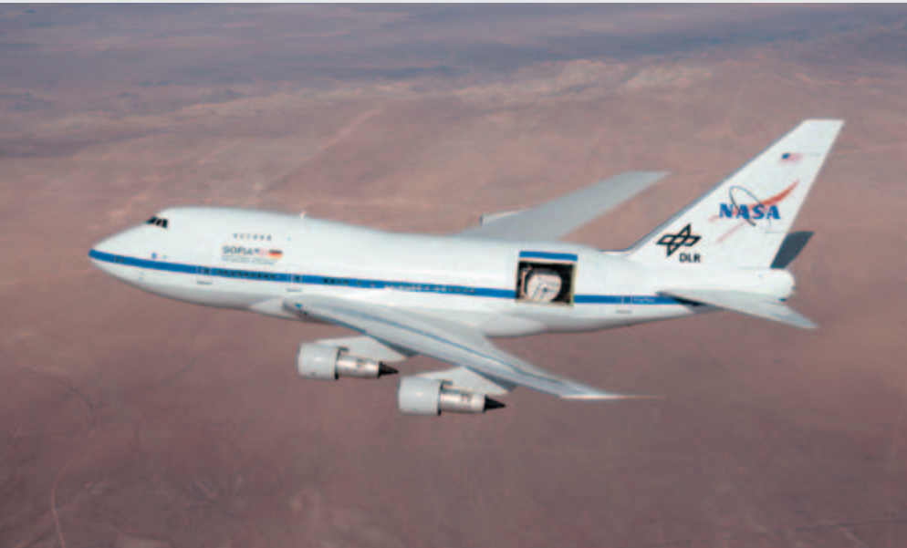
Das Stratosphären-Observatorium für Infrarot-Astronomie SOFIA während seines ersten Testfluges mit vollständig geöffneter Teleskop-Tür am 18. Dezember 2009 über der kalifornischen Mojave-Wüste. In der Öffnung im Rumpf der Boeing 747SP wird das in Deutschland gebaute 2,7-Meter-Teleskop sichtbar. Der Testflug mit geöffneter Tür ermöglichte den Ingenieuren zum ersten Mal, die Luftbewegungen in und um Teleskop und Tür zu untersuchen.
