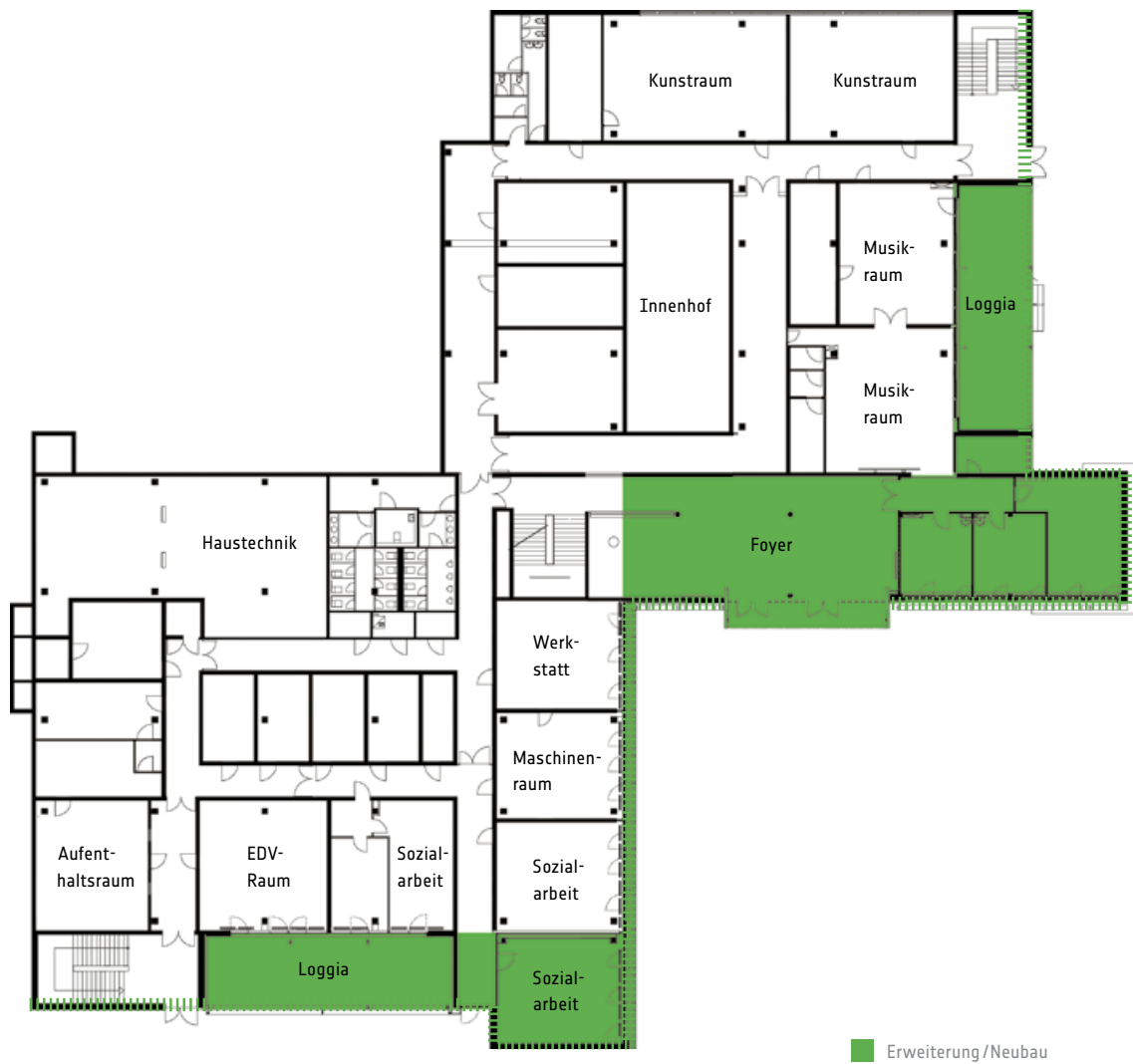
Abb. 121: Umbau Erdgeschoss Bauteil A/B, M 1:500
