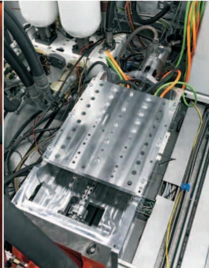
Der Lineargenerator koppelt die durch die Verbrennung zugeführte Energie elektrisch aus. In der hier dargestellten Version können bis zu 20 Kilowatt gewonnen werden.
