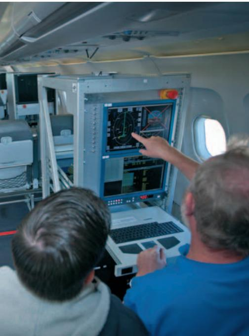
DLR-Wissenschaftler überwachen aus der Kabine das Advanced Flight Management System, kurz AFMS
