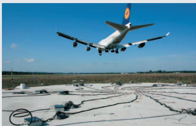
Flug einer Boeing 747 über ein Mikrofon-Array
