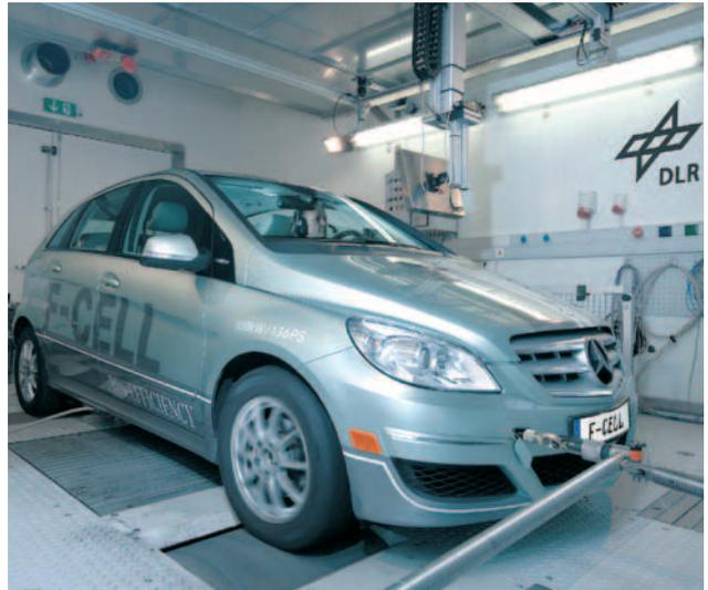
Brennstoffzellenfahrzeug im Stuttgarter Prüfstand
