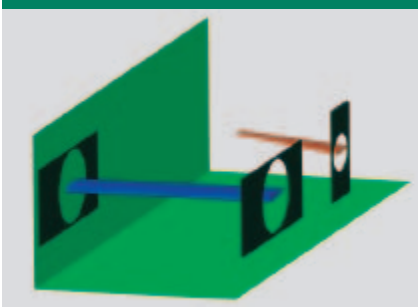
Windkanalmodell aus zwei generischen Tragflügeln. Windrichtung von vorn. Der blaue Flügel dient zur Erzeugung von Böen oder einer durch Buffet erzeugten instationären Strömung. Die dynamische Reaktion des roten Flügels wird gemessen.
