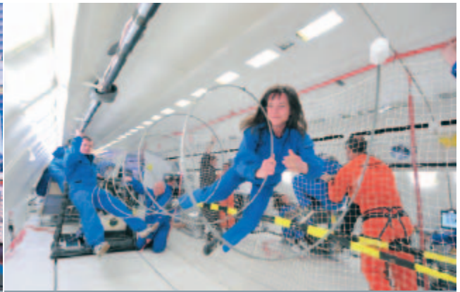
Ob sich die Antenne später unter Schwerelosigkeit wunschgemäß entfalten wird, kann nur im Rahmen eines Parabelflugs wirklichkeitsnah getestet werden. Deshalb flog bei der jüngsten Parabelflugkampagne im März 2010 unter anderem auch die Helix-Antenne des AISat in vier verschiedenen Testversionen mit. Gemeinsam mit Ihren Kollegen versucht Annette Bäger herauszufinden, welches Antennenkern-Material am besten geeignet ist.
