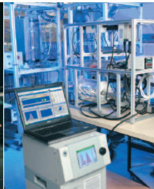
Die Rußpartikel im Blick – Analysegeräte zur Untersuchung der Schadstoffemissionen neuer Treibstoffe im DLR-Institut für Verbrennungstechnik
