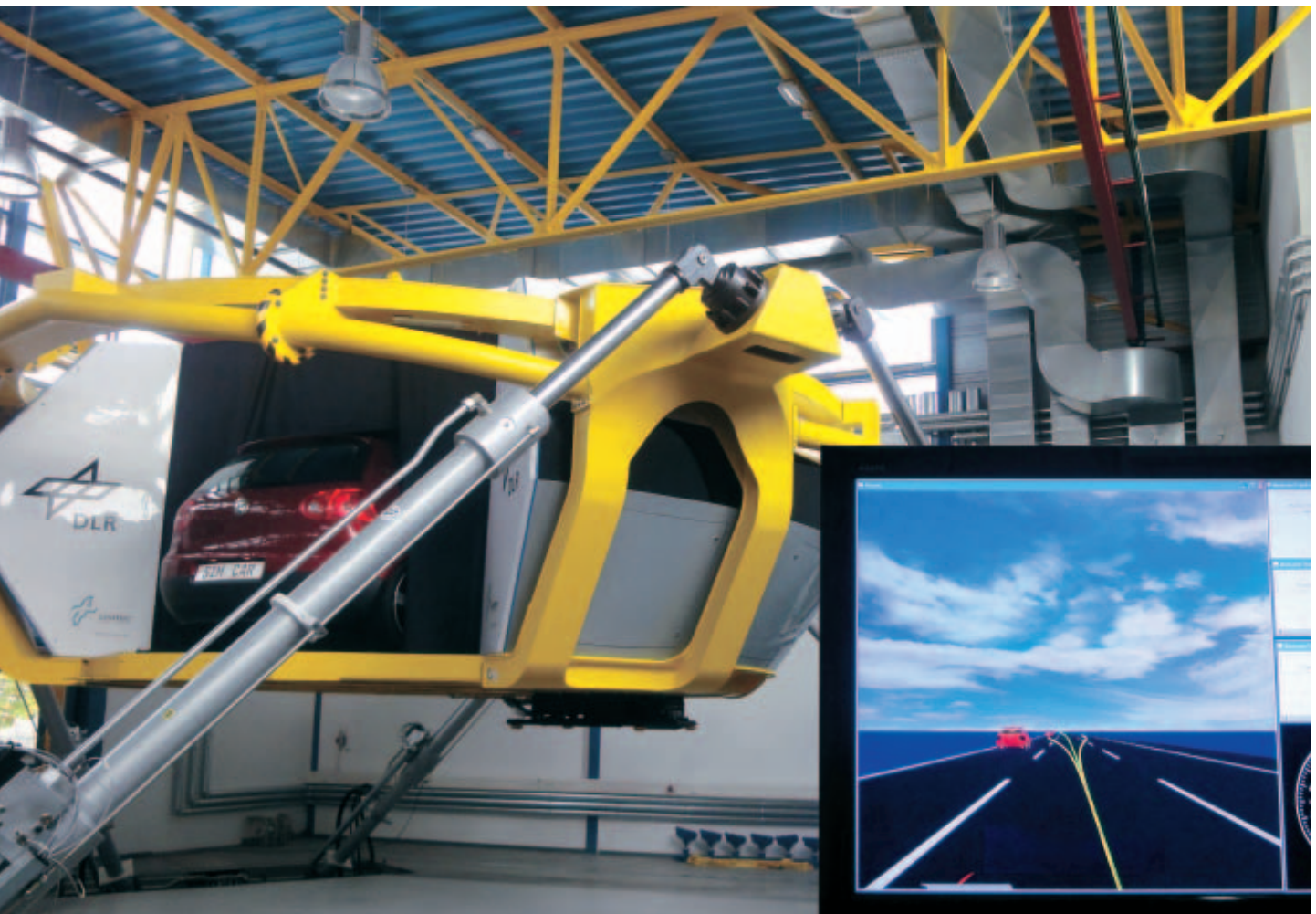
Der Prototyp des Fahrassistenz- und Automationssystems wurde im dynamischen Fahrsimulator des DLR-Instituts für Verkehrssystemtechnik getestet
