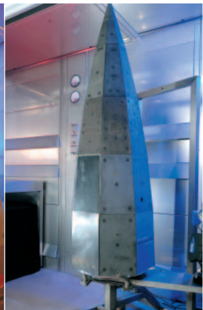
Die facettierte Form des Hitzeschutzes verspricht auch bessere aerodynamische Eigenschaften
