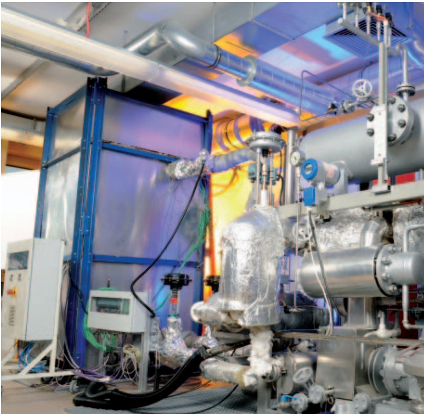
Mit dieser 10-Kilowatt-Versuchsanlage werden unterschiedliche Wärmespeicher von bis zu 400 Grad Celsius untersucht. Der Speicherbehälter (links im Bild) mit externer Isolierung fasst 100 Liter und kann mit unterschiedlichen Flüssigspeichermedien auf Salzbasis betrieben werden. Im Vordergrund rechts ist der Thermoölkreislauf zu sehen, er wird für die Wärmezufuhr bzw. -abfuhr beim Laden und Entladen des Speichers benötigt.
