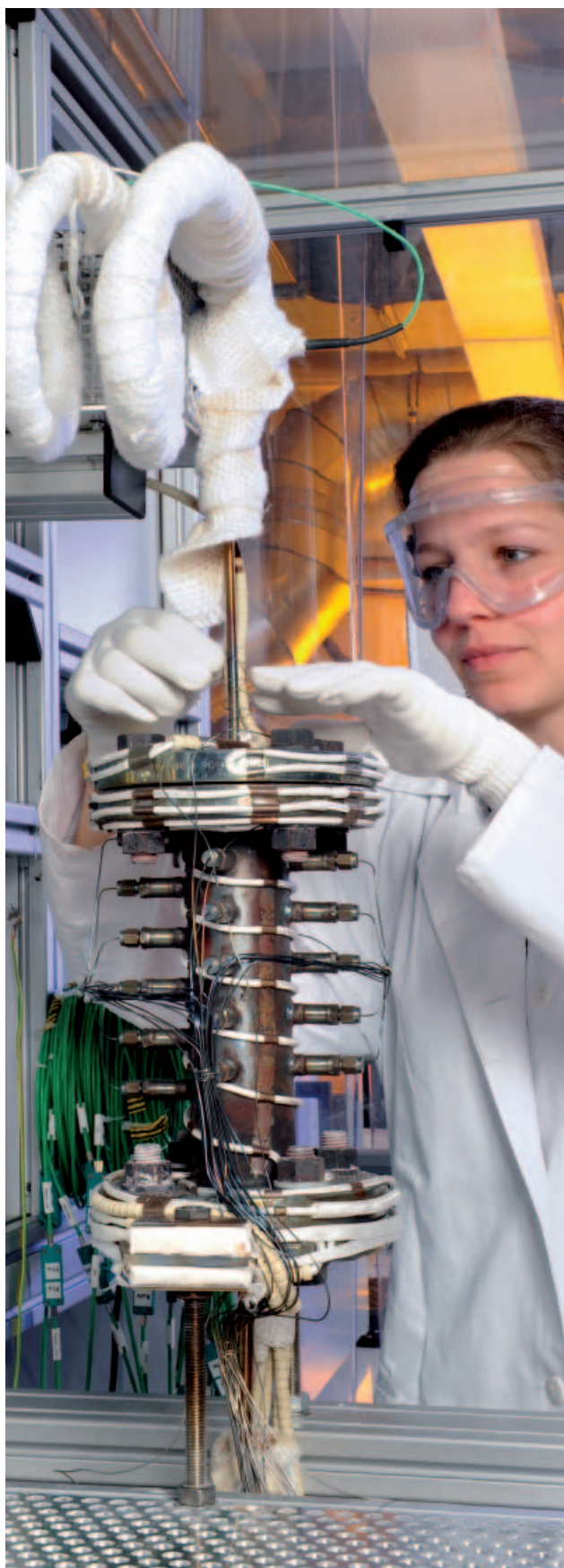
Neue Wärmespeicher im Test: DLR-Forscherinnen und -Forscher untersuchen, welche Eigenschaften pulverförmiges Calciumhydroxid als chemischer Wärmespeicher hat. Das Bild zeigt, wie Heizschnüre an einem Speicherreaktor befestigt werden. Das Calciumhydroxid befindet sich im Inneren des mit Thermoelementen ausgerüsteten Speicherreaktors.
