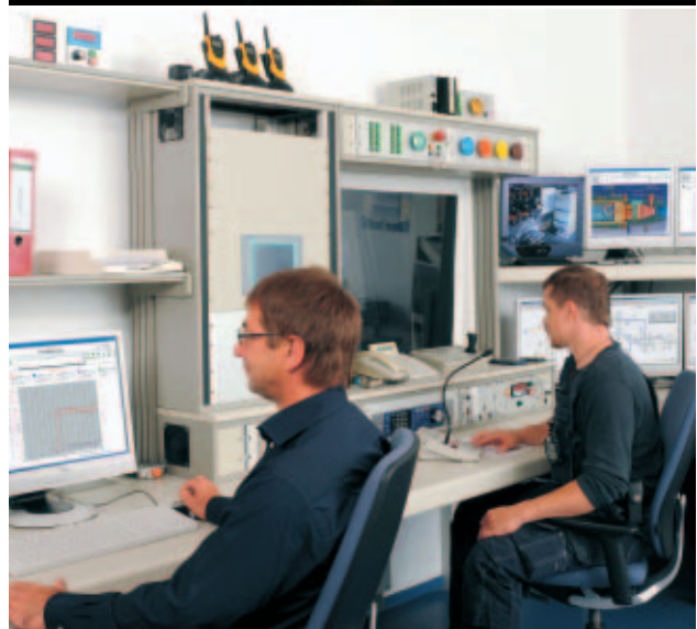
Oben: Das Herz des Prüfstands, die Brennkammer mit optischem Zugang. Mitte: Die Flamme im Blick, von einer Überwachungskamera aufgenommen. Unten: Wegen des Lärms und der hohen Temperatur- sowie Druckverhältnisse betreiben ein Messtechniker, in diesem Fall Dr. rer. nat. Ulrich Meier (links), und ein Prüflingenieur, hier André Mögelin, die Leitwarte der Anlage in gebotener Distanz.
