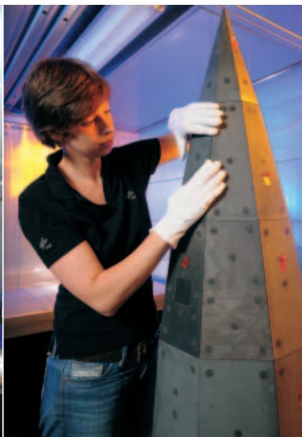
Die letzten der eckigen Hitzeschutzkacheln werden montiert
