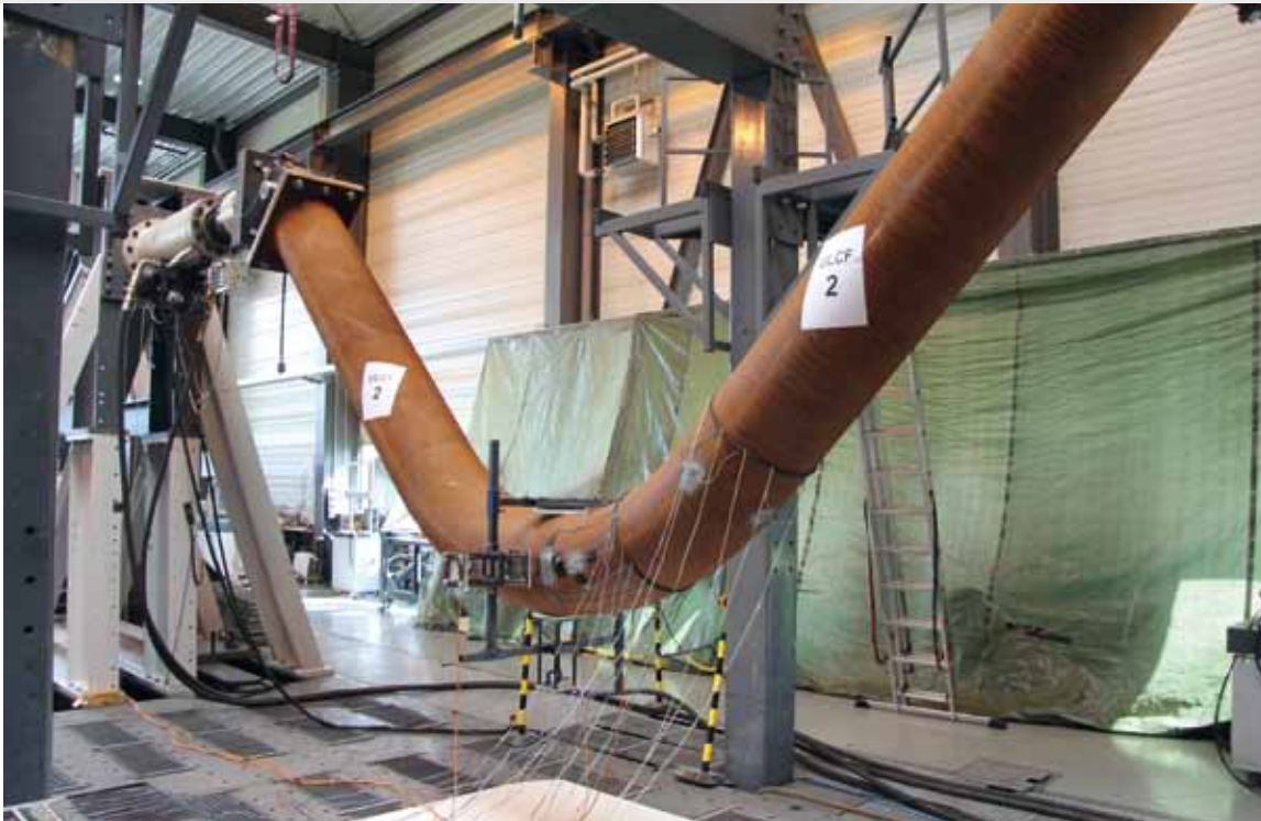
Bild 1: Konfiguration der ULCF-Versuche an Pipelinebögen im Zentrum Metallische Bauweisen (ULCF – Ultra Low Cycle Fatigue). Foto: Institut für Stahlbau
