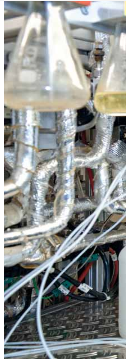
Bild 1: Laborgasprüfstand zur Untersuchung von Proben aus Abgaskatalysatoren. Foto: Peter Winandy
