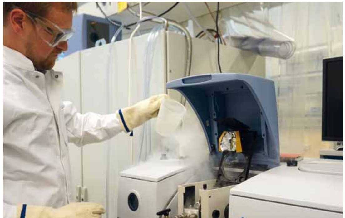
Bild 3: Versuchsreaktor zur Untersu- chung der katalytischen Aktivität. Foto: ACA
