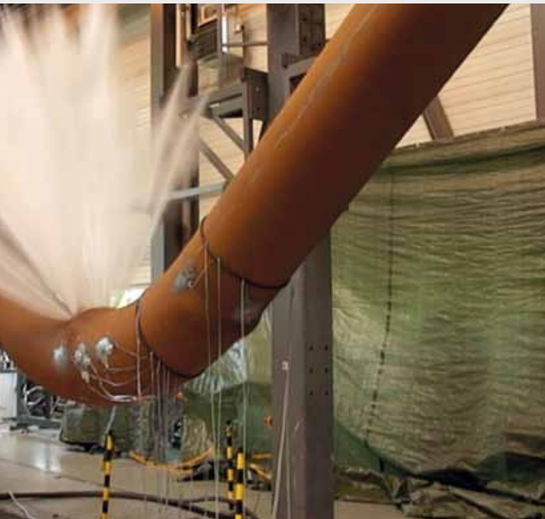
Bild 2: Versagen vom Pipelinebogen nach 37 Belastungszyklen. Foto: Institut für Stahlbau
