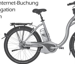
*Der zentral eingebaute Elektromotor von Panasonic hat eine Motorleistung von 250 W und ist mit der NEXUS 8-Gang-Narbenschaltung von Shimano für alle Tretbereiche gut ausgerüstet.*
