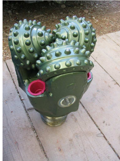
Abbildung 5: 17 1/2" Warzenmeißel vor seinem Einsatz an der Bohrstelle
