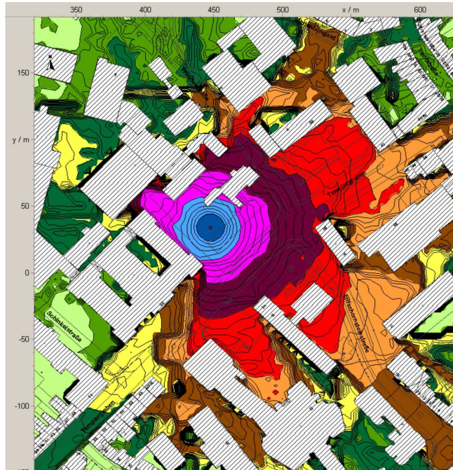
Abbildung 2: Schallausbreitungsmodell der Bohrung "RWTH-1"
