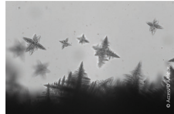
Kristallbildung in der Schmelze: Das Experiment TRACE+ beschäftigt sich mit den Vorgängen, die während der Erstarrung metallischer Legierungen ablaufen. Gut beobachten kann man beispielsweise die Bildung von Kristallen in der Schmelze.
