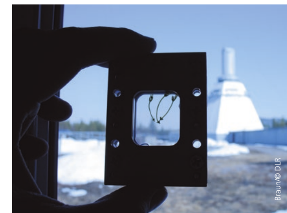
Blick durch eine TEXUS-Probenkammer für Algen, im Hintergrund der TEXUS-Startturm
