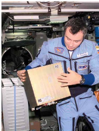
Kosmonaut Vladimir Dezhurov installiert das Global Time System (GTS) im Swesda-Modul der Raumstation.
