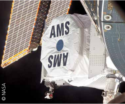
Das Alpha-Magnet-Spektrometer (AMS-02) sitzt an der Außenseite der Internationalen Raumstation ISS. Das vom DLR geförderte Projekt zeichnet jährlich 16 Milliarden Teilchen der kosmischen Strahlung auf.
