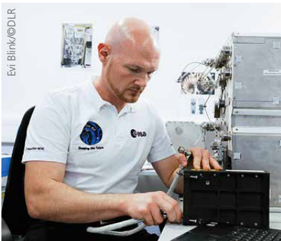
In der Schwerelosigkeit werden Legierungen zukünftig behälterfrei mit der EML-Anlage geschmolzen. Der deutsche ESA-Astronaut Alexander Gerst trainiert am EAC in Köln, wie sie funktioniert. Er wird EML auf der Raumstation in Empfang und in Betrieb nehmen.
