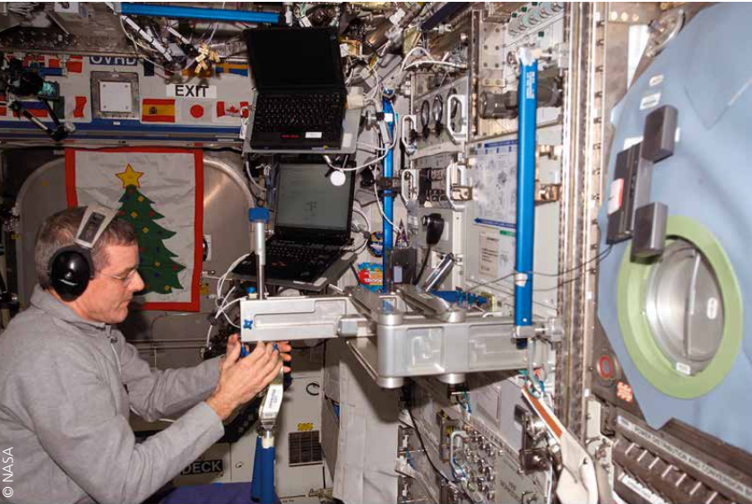
ISS Astronaut Bill McArthur überprüft die SLAMMD-Apparatur. Das Gerät bestimmt die Masse von Astronauten. Die Erfassung der Masse im Weltraum ist schwierig, weil sie in Schwerelosigkeit nicht mit dem Gewicht gleichzusetzen ist.
