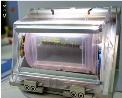
In BIOLAB-Experimentcontainern wird das Wurzelwachstum der Ackerschmalwand unter verschiedenen Stufen der Schwerkraft sowie in Schwerelosigkeit untersucht. Das Bild zeigt einen Probeversuch im DLR-Nutzerzentrum für Weltraumexperimente (MUSC).
