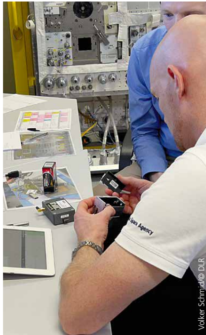
Das deutsche WiSeNet-Experiment, das Alexander Gerst auf der Raumstation durchführt, sammelt über kabellose WLAN-Sensoren wichtige Daten wie Temperatur, Lichtstärke, Vibrationen, Luftfeuchtigkeit und Luftdruck im Columbus-Modul. Aus diesen Energiequellen kann man kleine Strommengen für mobile Geräte mit geringer Leistung gewinnen.
