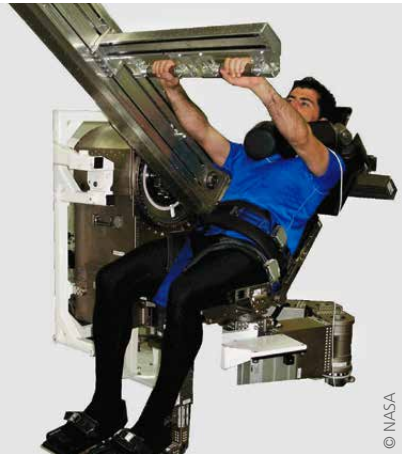
Mit dem Muscle Atrophy and Resistance Exercise System (MARES) lässt sich dem Muskelabbau in Schwerelosigkeit entgegenwirken.
