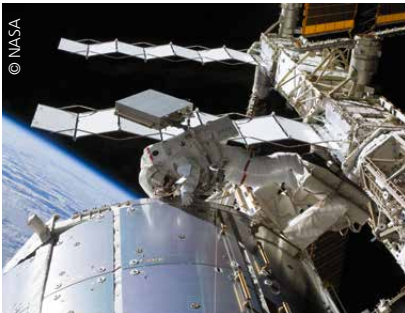
Die Astronauten John Olivas und Nicole Stott demontieren am 1. September 2009 in einem sechseinhalbstündigen Außenbordeinsatz die Expose-EuTEF (European Technology Exposure Facility) mit den Expose-E-Proben, um sie zur Erde zurückzubringen.
