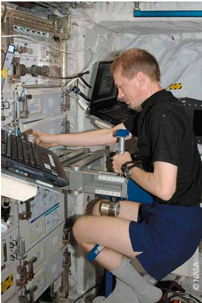
ESA-Astronaut Frank De Winne bei einer Überprüfung der SLAMMD-Hardware. Das Gerät bestimmt die Masse der Astronauten in Schwerelosigkeit.
