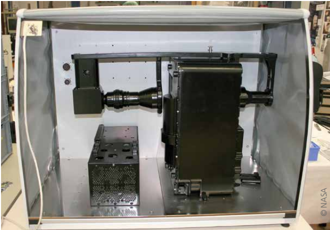
Im Mission Control Center in Huntsville wurde eine zweite CCF Experimenteinheit in einem Modell der Microgravity Science Glovebox installiert. Diese zweite Einheit erlaubt Wissenschaftlern und Ingenieuren, vom Boden aus Versuchsszenarien zu simulieren.
