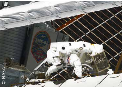
Am 16. Mai 2011 transportierte das Space Shuttle Endeavour das Alpha-Magnet-Spektrometer AMS-02 zur ISS. Dort wurde die Teilchenkamera an der Außenseite installiert, um mit ihren Detektoren die kosmische Strahlung zu erfassen.
