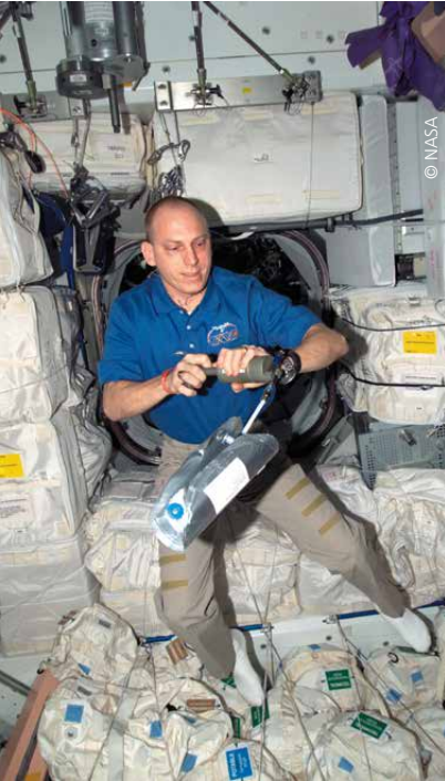
Astronaut Clay Anderson sammelt mit einer Pumpe Luftproben, die vom Analysing Interferometer for Ambient Air (ANITA) im Unity-Verbindungsknoten analysiert werden.
