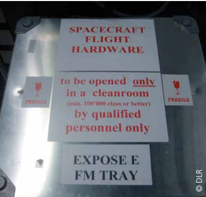
Die Expose-E-Proben sind für den Transport zur ISS vakuumdicht verpackt.
