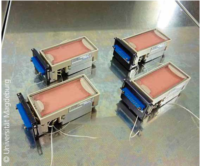
Zellkulturen auf engstem Raum: Die CellBox-Experimentkammer ist etwa smartphonegroß. Das Foto zeigt die Kammer mit Pumpe und Tanks für die Nähr- und Fixierlösung der Zellen.
