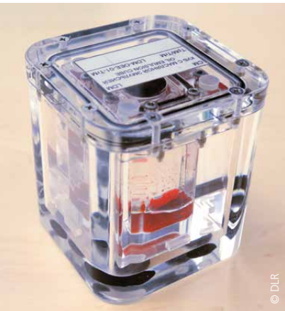
„The Cube:“ Ein eng verschlossener Plexi-glascontainer mit doppelten Wänden mit einer Ölmischung für das ISS Schülerexpe-riment. Das Wasser ist rot gefärbt.
