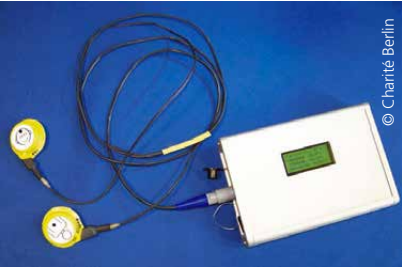
Der nicht-invasive Doppelsensor zur Messung der Körperkerntemperatur beim Experiment Thermo
