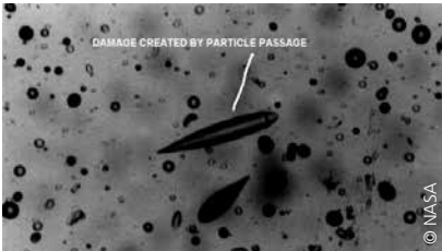
Durchgang eines Strahlenpartikels durch eine Plastikkernspurdetektorfolie von DOSMAP
