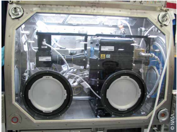
Im Mission Control Center in Huntsville wurde eine zweite CCF Experimenteinheit in einem Modell der Microgravity Science Glovebox installiert. Diese zweite Einheit erlaubt Wissenschaftlern und Ingenieuren, vom Boden aus Versuchsszenarien zu simulieren.
