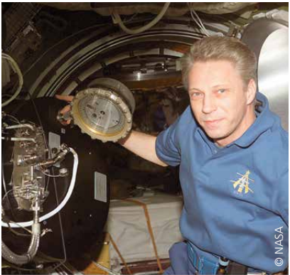
Der deutsche ESA-Astronaut Thomas Reiter forschte mit Hilfe der PK-3-Plus-Apparatur im russischen Swesda-Modul der ISS an der Entstehung von komplexen Plasmen unter Schwerelosigkeit.
