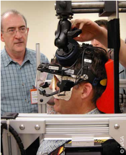
Astronauten testen die Otolith-Anlage mit dem DLR Eye-Tracking-Device zur Messung der Augenbewegungen in Houston.
