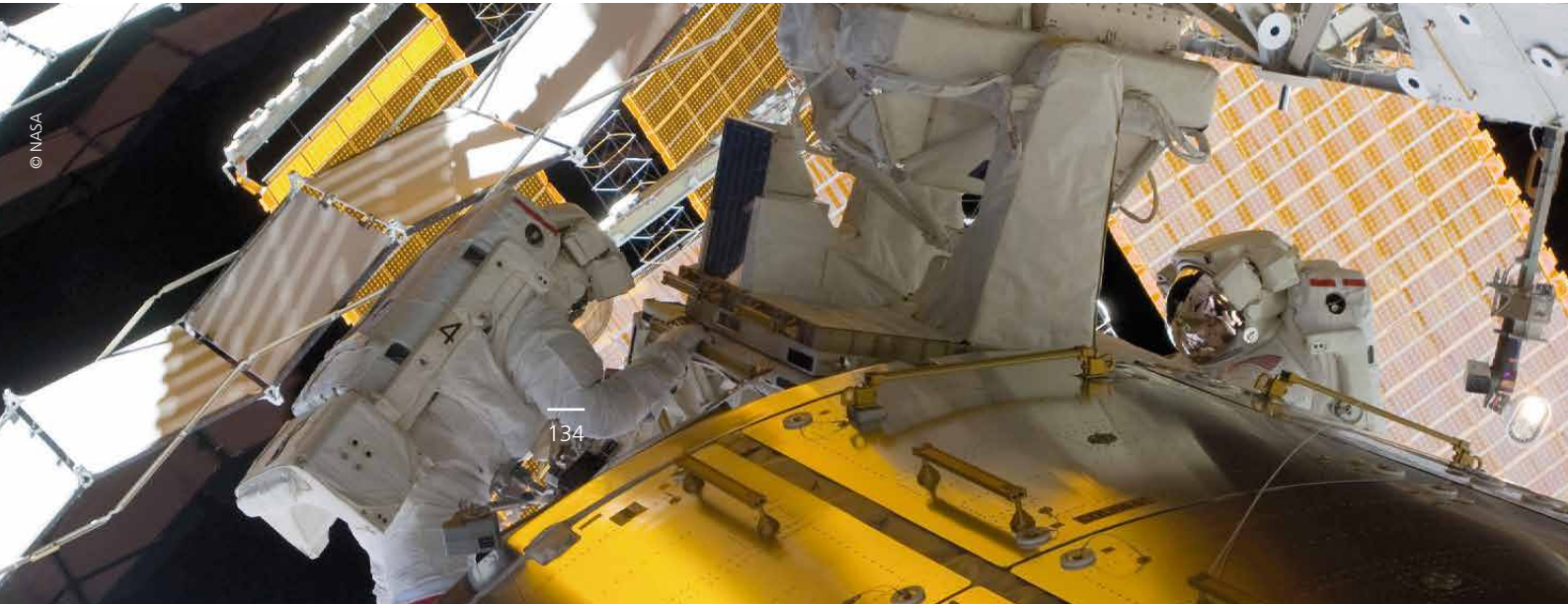
Die Astronauten John Olivas und Nicole Stott bei der Arbeit außen am Columbus-Modul: Sie entfernen die Expose-EuTEF-Anlage mit den Expose-E-Proben, um sie zur Erde zurückzubringen.
