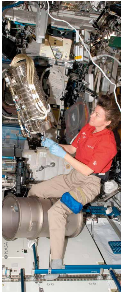
NASA-Astronautin Catherine Coleman entfernt den Low Gradient Furnace (LGF)-Ofeneinsatz aus dem MSL und installiert stattdessen den Solidification and Quenching Furnace (SQF)-Ofeneinsatz für die zweite Probenreihe von CETSOL.
