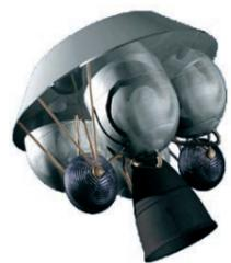
Die Oberstufe der Ariane 5ES wird von einem Aestus-Triebwerk angetrieben. Es zündet insgesamt dreimal, um die europäischen Raumfrachter ATV auf Kurs zu bringen.
