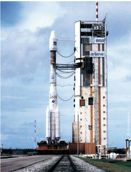
Eine Ariane 44L bereit zum Start in Kourou, Französisch-Guyana. Zusätzlich zu den Haupttriebwerken besaß die 44L vier Flüssigtreibstoffbooster als Zusatztriebwerke.
