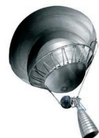
Die Oberstufe der Ariane 5ECA wird vom Triebwerk HM-7B angetrieben. Mit dieser Oberstufe werden vor allem kommerzielle Satelliten auf ihre Umlaufbahnen befördert.
