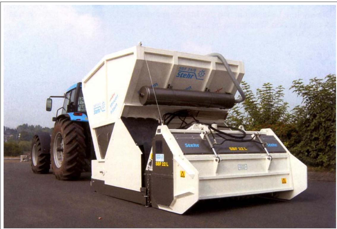
Bild 11.5: Kombinierte Verteil- und Fräseinrichtung
