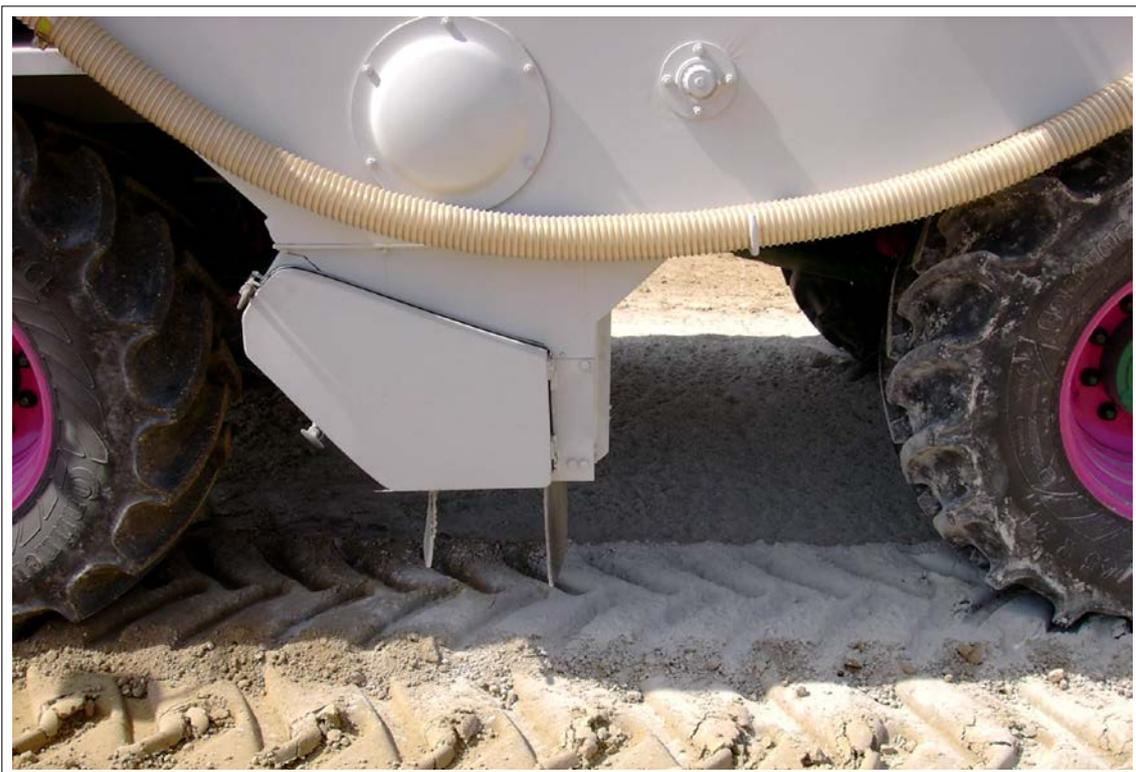
Bild 11.3: Verteileinrichtung
