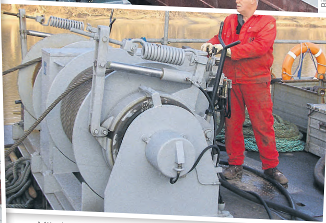
Mit der Winde wird der Kran exakt manövriert.
