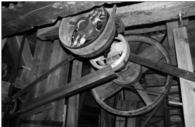
Haupttransmission zum Antrieb der Müllereimaschinen
