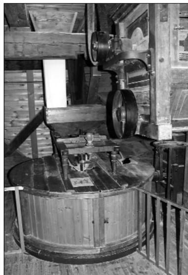
Mahlgang mit Bütte, Trichter und Rüttelschuh
