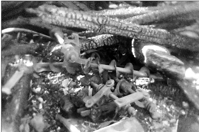
**Am 11. April 2009 brannte die Windmühle in Bansin-Dorf am Abzweig nach Sellin bis auf die Grundmauern nieder. Hier die Reste einer Transportschnecke und Transmissionsteile einschließlich Lagerschalen.**
