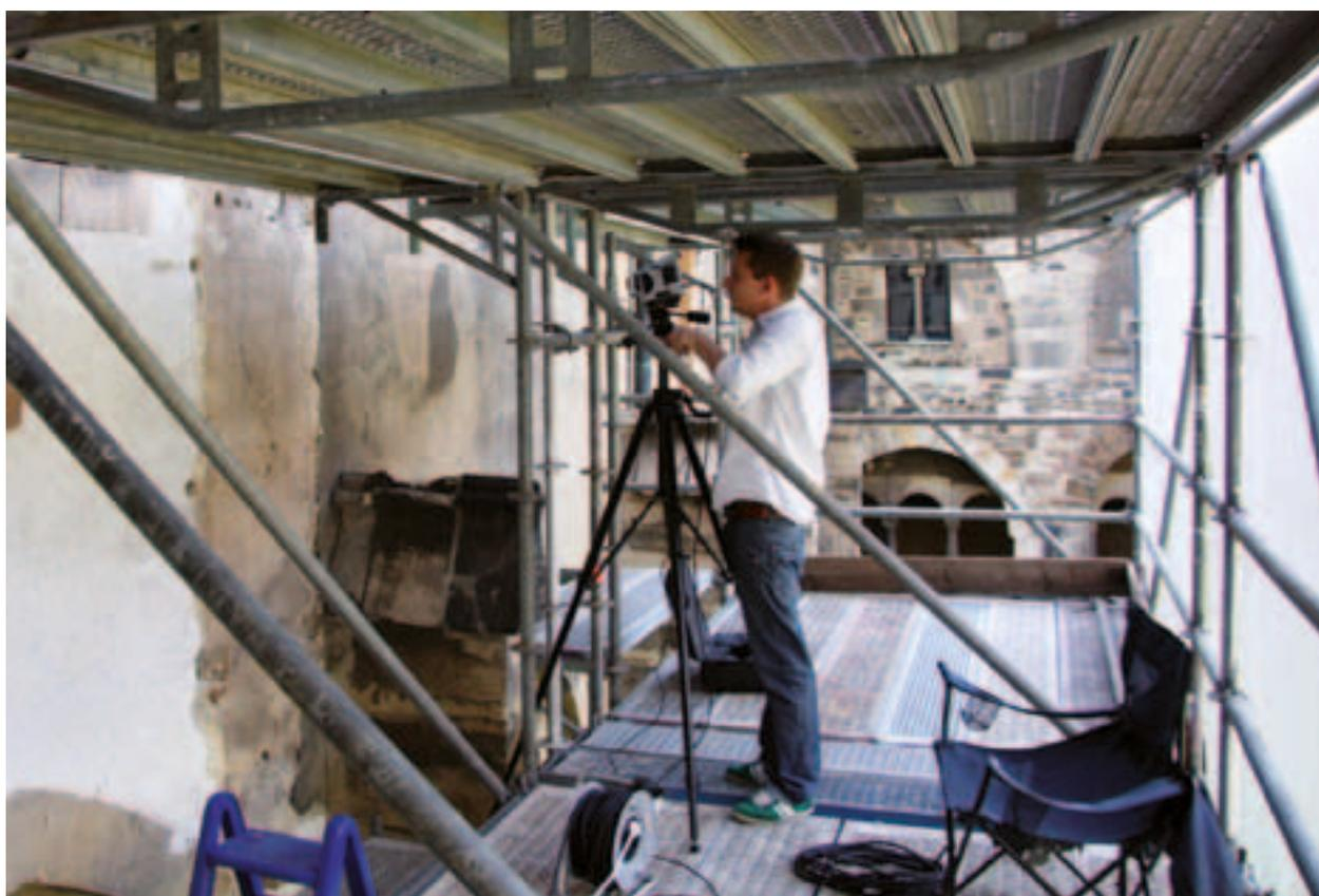
**Abbildung 4a:** Erfassung von Thermografiesequenzen der Putzoberfläche am Magdeburger Dom nach künstlicher Erwärmung
