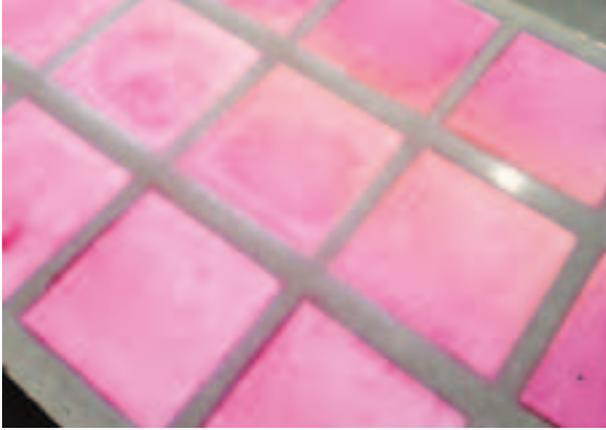
Prototyp einer DysCrete-Solarzelle, Versuchsreihe mit roten Farbstoffen
