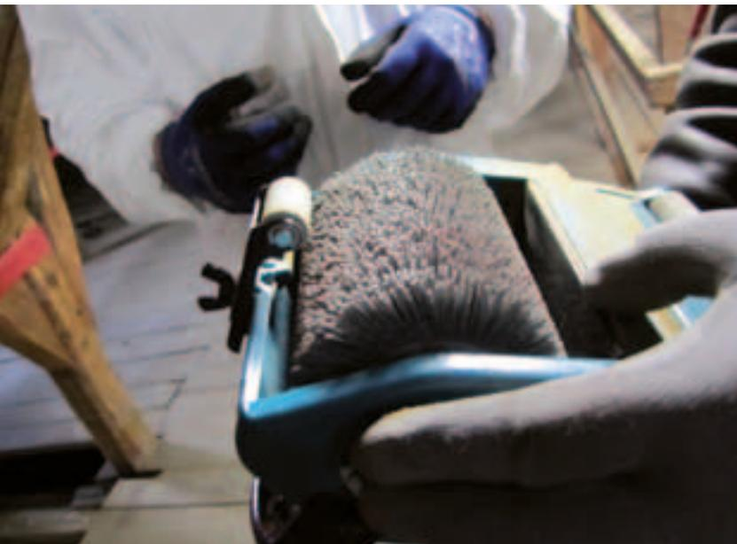
Zur Reinigung eingesetzte rotierende Kunststoffbürste
