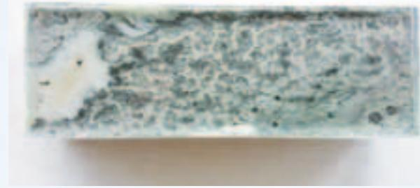
Prototyp einer DysCrete-Solarzelle, Versuchsreihe mit grünen Farbstoffen
