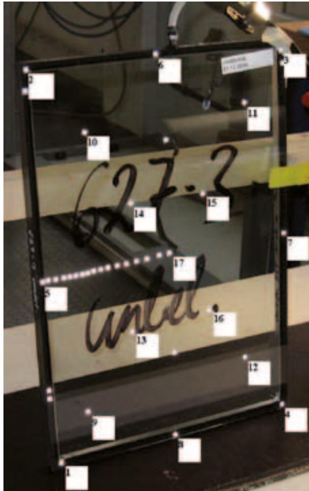
Vorbereiteter Probekörper zur experimentellen Untersuchung des Verformungsverhaltens von Mehrscheiben-Isolierglas mit dünnen Gläsern
