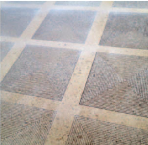
Ein leitfähiger Beton bildet den Rückkontakt des DysCrete-Solarzellenmoduls
