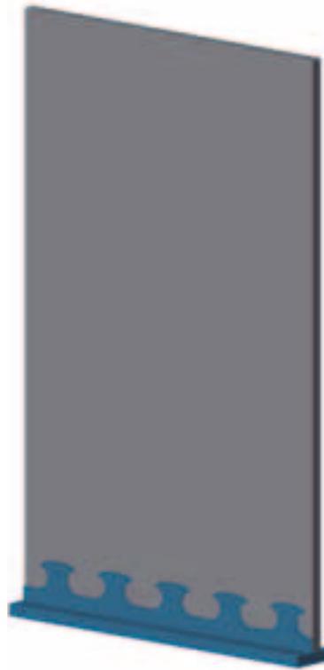
**Abbildung 5:** Versuchskörper zur Ermittlung der Einspannung (mit geschnittener UHPC-Scheibe dargestellt.)
