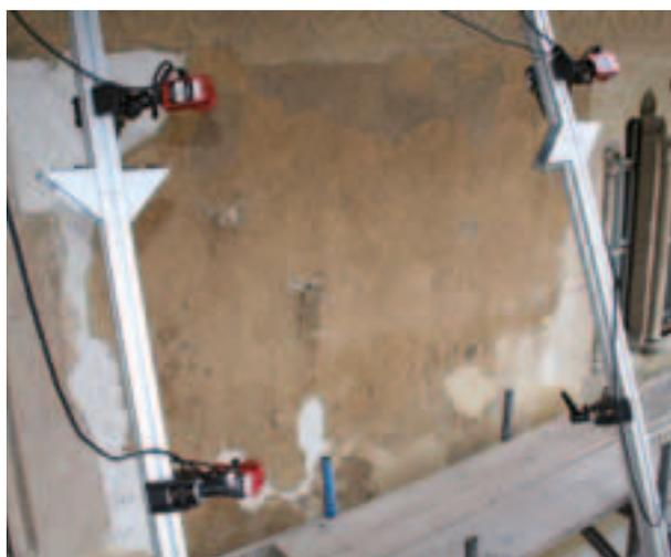
Abbildung 1a und 1b: Riss-Trackingsystem mit Tastsensor (a) und Kamerasystem (b)
