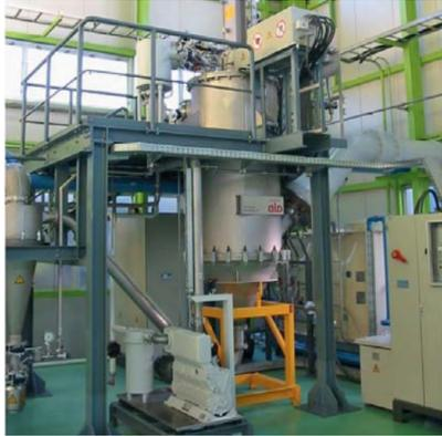
Pulververdünsungsanlage zur Entwicklung werkstofftechnischer Innovationen Bild: ALD Vacuum Technologies
