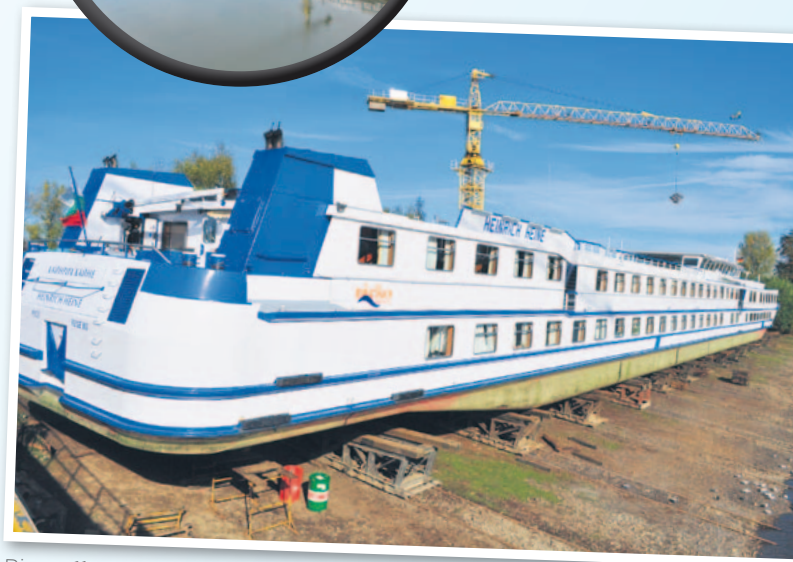
Bis zu 110 Meter lange Flusskreuzfahrtschiffe kann die Hellinganlage aus dem Wasser ziehen.
