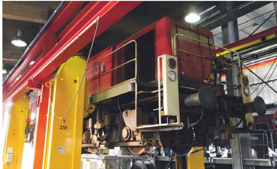
Pediküre bei einer DB-Lok auf der Radsatzdrehbank der HGK.
