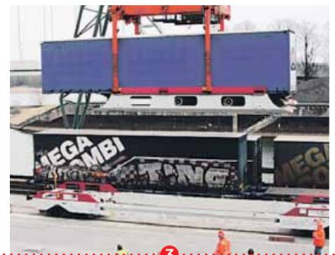
Testlauf. Sattelaufleger auf die Bahn verladen, direkt am Terminal und ohne vorherigen Hub – das verspricht das innovative System von CargoBeamer. Noch ist der Prototyp in einer Erprobungsphase, für die Kräne und Umschlagterminals
