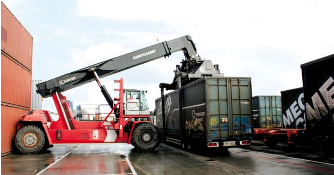
Mit Reach-Stackern kommt die Ladung von der Schiene auf die Straße | Bilder: Mainzer
